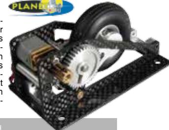
Seglereinziehfahrwerke für viele Anwendungen wo kein extra Servo Platz findet oder nicht zur Anwendung kommen soll. Das Fahrwerk wird durch einen kräftigen Getriebemotor betätigt und wird einfach an einem freien Empfängerkanal angeschlossen. Das Gehäuse besteht aus Carbon, die fahrwerkschwinge ist aus Aluminium. Lieferung erfolgt mit Rad. Robust, Zuverlässig und einfach in der Montage! (L/B/H: sind maximal Abmessungen).
