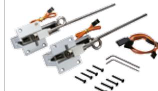
**ELEKTRISCHES EINZIEHFahrWERK 60-120 95°**
