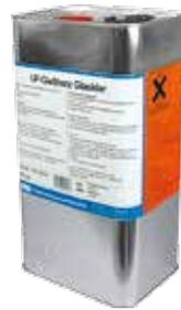
EP-Gelcoat farblos, transparent, mit EP-Farbpasten einfarbbar, thixotrop. Unter Vakuum hergestellt, daher optimal luftblasenfrei und homogen. Nicht UV-beständig Kann durch Wassereinwirkung eintrüben. Verbrauch ca. 0,3 kg/m<sup>2</sup>. Verarbeitung mit Härter S (15 min), L (40 min) und EPH 161 (90 min, erhöhte Wärmeformbeständigkeit).
