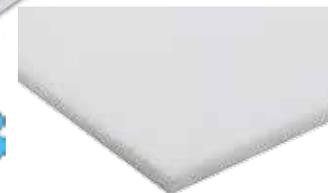
Vernetzter PVC-Hartschaumstoff: • Verrottungsbeständig • Gute thermische Isolation • Selbstverlöschend, günstiges Brandverhalten • Geringe Harzaufnahme • Gute Styrolverträglichkeit • Kann problemlos bis 65 °C getempert werden • Toleranzen: Plattendicke ± 0,5 mm, Länge und Breite ± 50 mm, Dichte 54-69 kg/m³
