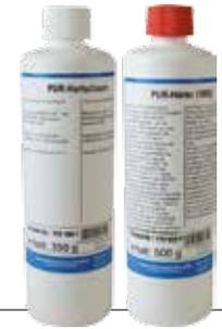
Hochelastischer, schnellhärtender 2-K Polyester-Feinspachtel. Zum Ausfüllen kleinerer Unebenheiten und zum dünnen „Feinspachteln“ schon vorbehandelter Flächen. Geeignet für Untergründe aus Metall, Holz, Beton oder auf mit prestolith plastic vorgespachtelte Untergründe. • schleifbar nach: ca. 30 Minuten • Topfzeit bei 20°C: ca. 8 Minuten • Temperaturbeständigkeit des ausgehärteten Materiales: bis 120°C • Beständig gegen: Säuren, Laugen, Treibmittel, Lösemittel, Wasser und Tausalze • Farbe: weiss
