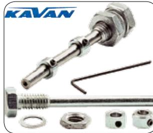
Radachsen aus Stahl. Einfache Demontage der Radverkleidungen da Montage der Radachse von der Fahrwerksinnenseite. (Entweder wird ein Gewinde passend zum Befestigungsgewinde in das Fahrwerk geschnitten oder die Achse wird in einer Bohrung ohne Gewinde mit der beiliegenden Sechskantmutter und der Beilagscheibe montiert)
