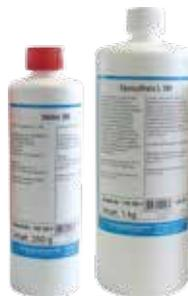
Chemikalienfestes, höherviskoses, lösemittel- und füllstofffreies Laminier- und Beschichtungsharz mit zum Teil sehr guter Beständigkeit gegen zahlreiche Medien wie z.B. Aromaten (Benzin), verdünnte Säuren und Laugen, Wasser, Alkohole etc. Mischungsverhältnis: 100 : 60 Gewichtsteile Harz : Härter, Verarbeitungszeit: 50 Minuten, Aushärtezeit: 24 Stunden.
