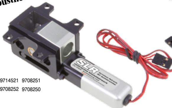
„Bugfahrwerksausführung für lenkbares Bugfahrwerk!“
