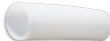
Der Teflonschlauch dient als Verbindungsstück zwischen Schalldämpfer und Krümmer. Aufgrund der sehr hohen Hitzebeständigkeit von ca. 260° C Dauertemperatur eignet sich dieser besonders für den Einsatz bei Hubschraubern und Benzin Motoren.
