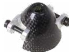
Speziell für die „RFM“ CFK-Klappluftschrauben konzipierte Spinner vom mehrfachen Weltmeister Rudolf Freudenthaler. Viele verschiedene Größe bis zu Spezialspinner mit Versatz sind erhältlich und decken nahezu jeden Einsatzbereich ab. Weitere Typen auf Anfrage!
