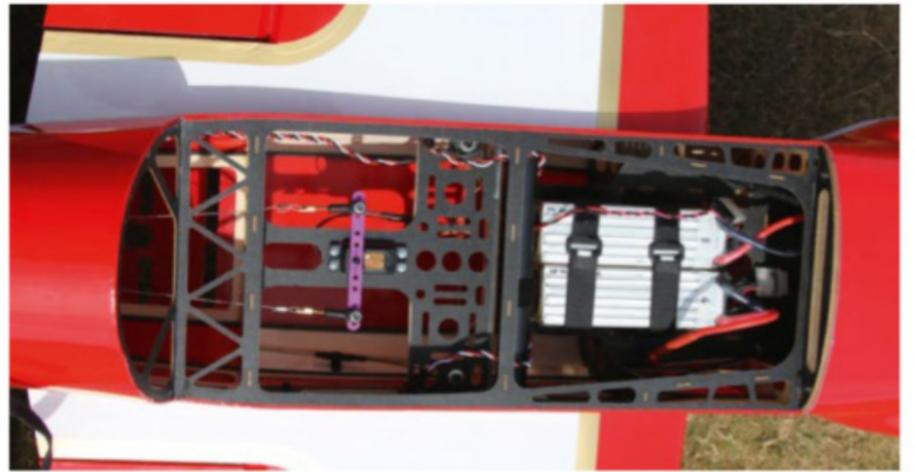
Comme toutes les dernières productions Extreme Flight, la structure du fuselage de ce Laser fait appel à un composite ctp/carbone: c'est léger, rigide et... joli! La verrière libère un large accès au fuselage, notamment pour installer, sangler et raccorder en série les deux LiPo 6S.
