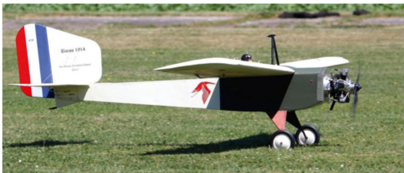
Passionné de Baron, Patrick Coly a agrandi le plan de Christian Chauzit à 200 % et installé un moteur O.S Sirius 5 cylindres en étoile de 50 cc qui ne rechigne pas à la tâche pour tirer les 16 kilos du monoplane.
