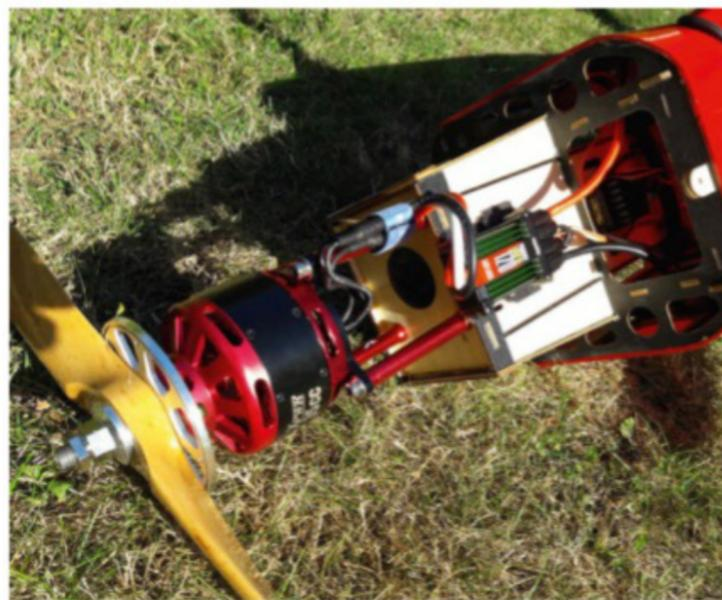
Sous le capot, le gros brushless de 3500 W trône au bout de colonnettes en alu ajustables en longueur. Sous la cabane, les trous de fixation du contrôleur HV 120 A conseillé sont déjà prévus.
