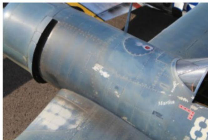
Le "Sublimissime" Corsair F4U de Yannick Bueb est issu d'un kit Carf Models complètement modifié. Il possède toutes les options comme les ailes repliables hydrauliquement et il affiche une finition exceptionnelle. L'envergure est de 2,85 m pour une masse de 24,5 kg, le moteur est un Moki 250 (5 cylindres en étoile). La décoration est celle de l'appareil de Papy Boyington de la VMF 214.
