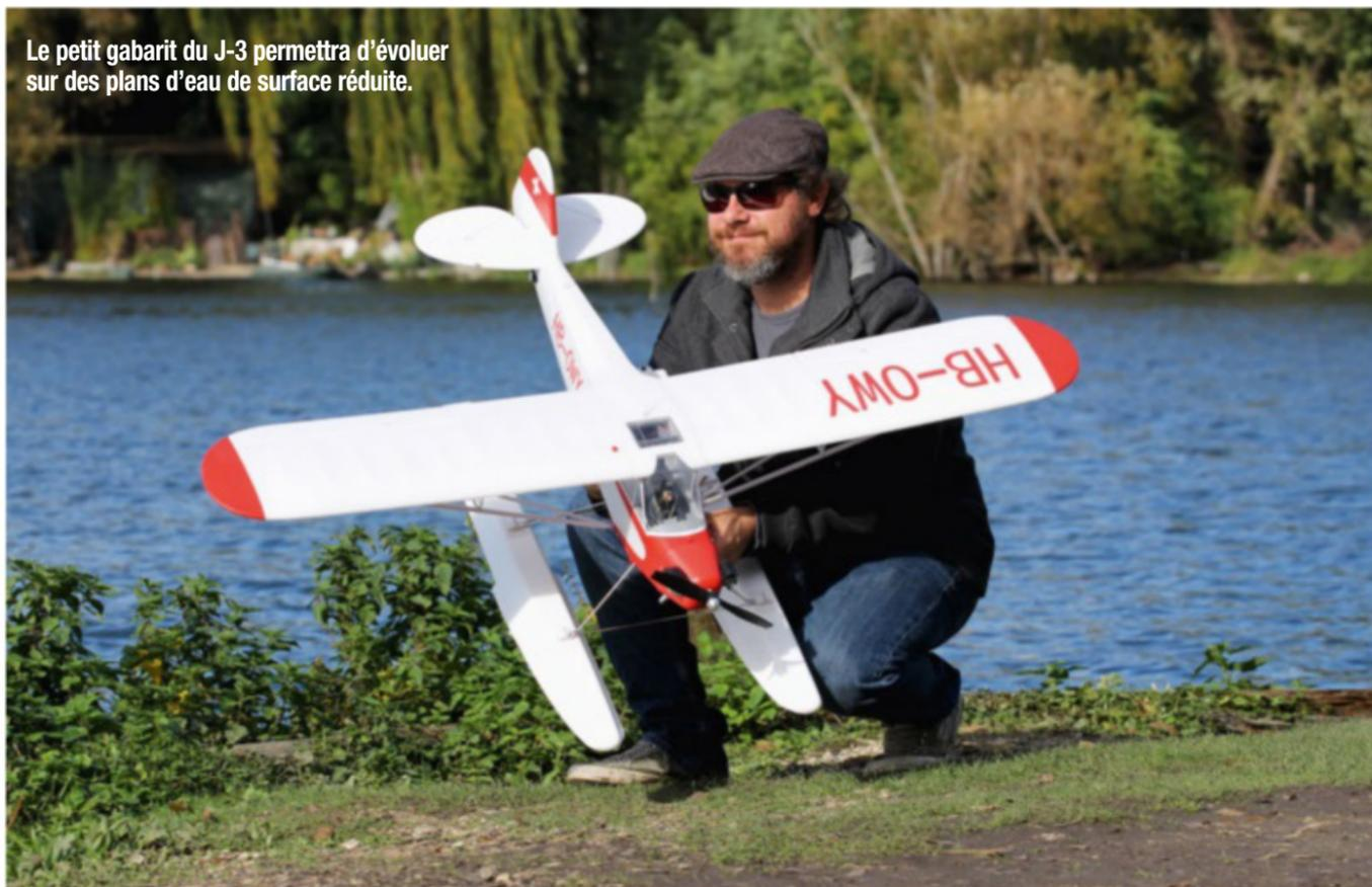
réalisées par la mousse EPO. La surface de la voilure présente des détails maquette tels que rivets, tôles, bouchons de réservoir, antennes, etc. L'aile est renforcée par des longerons en fibre et la décoration est entièrement réalisée en usine. Des fourreaux en tubes en plastique sont destinés à recevoir la clé d'aile réalisée en
