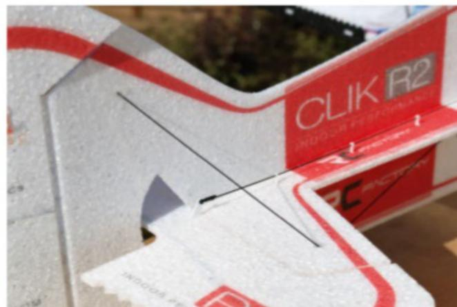
Les guignols sont en plastique et les chapes se clipent directement dedans. Côté servo, des dominos sont prévus par le constructeur, ici remplacés par l'auteur par des cordes à piano pliées en Z.
