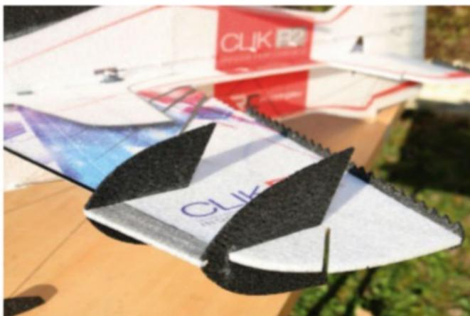
De larges SFG (Side Force Generator) sont présents sur la voilure, ainsi que des turbulateurs (freins) sur les bords de fuite.
