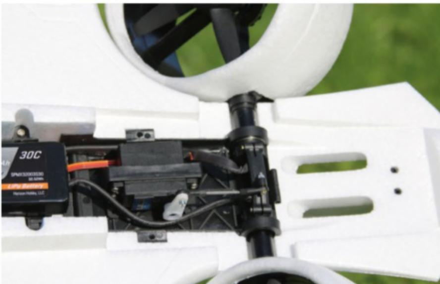
Caché sous les dérives, ce servo avec un couple de 10 kg.cm est chargé d'orienter les turbines arrière.
