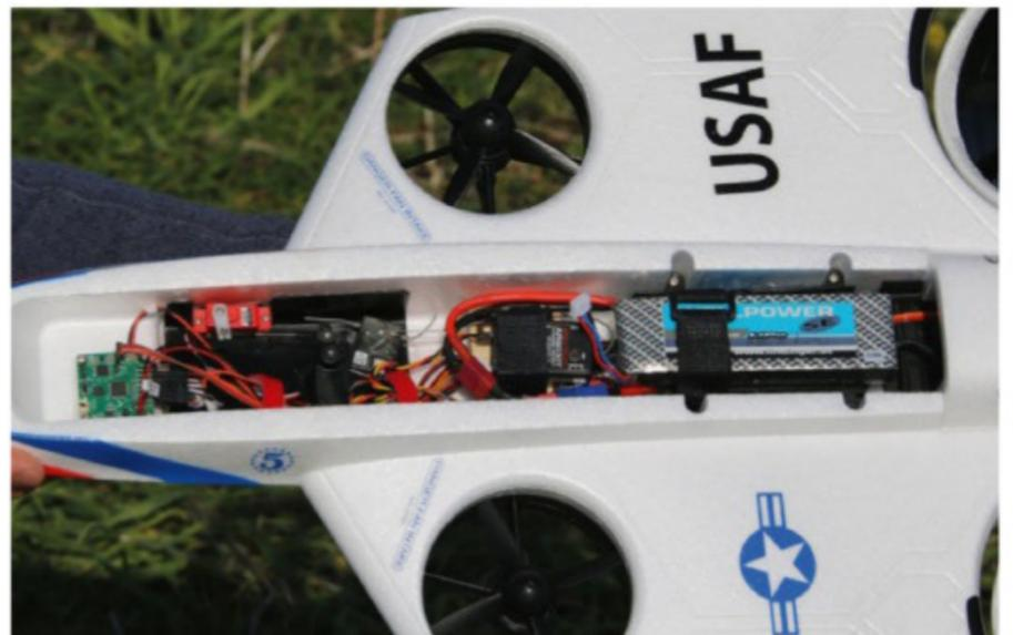
Le capot supérieur assure un bon accès. De gauche à droite: la carte électronique FlexF3, le servo de la roue avant directrice, le récepteur, et enfin l'accu LiPo 3S 3200 mAh.
