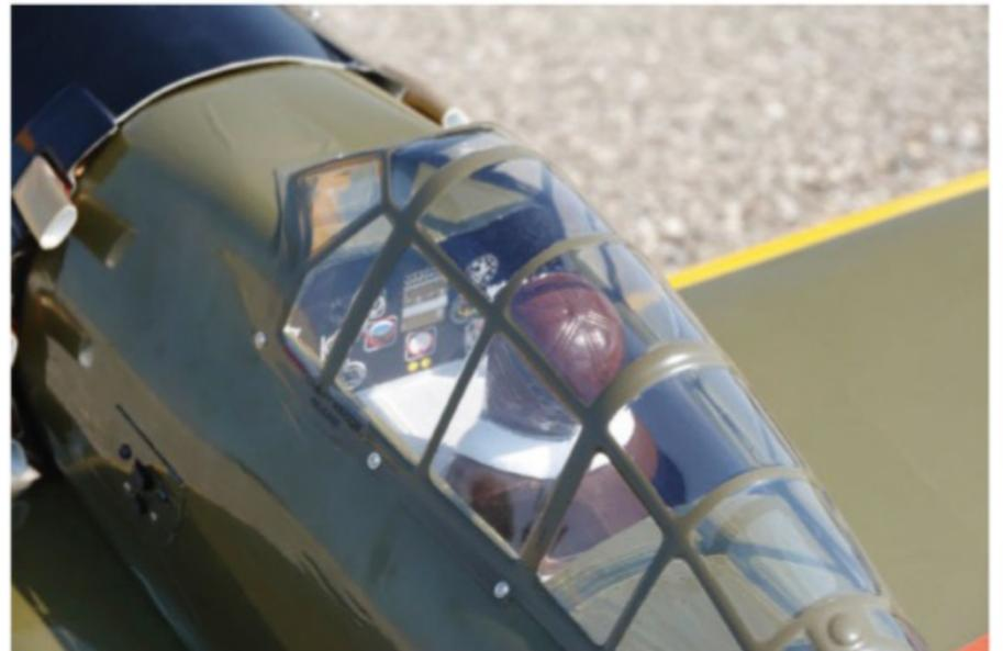
La verrière est vissée et collée au silicone, le buste de pilote est fourni dans le kit. Le tableau de bord est mis en place en usine, il s'agit d'un simple autocollant.
