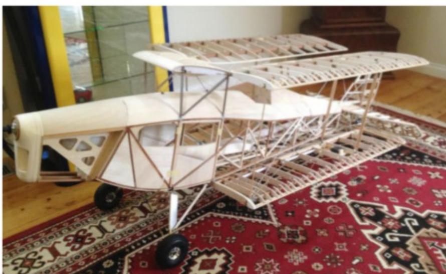
Les ailes se replient sur le côté du fuselage. La cinématique du réel a bien entendu été respectée.
