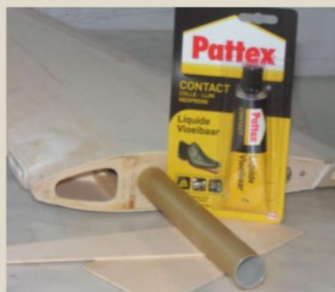
Les colles néoprènes dites « contact » peuvent être utiles pour les coffrages. J'en utilise uniquement lorsque je coffre la partie avant et très courbée d'une voilure: cela permet d'obtenir un collage instantané du bord d'attaque. Il n'y a plus alors qu'à positionner le reste de la planchette.
