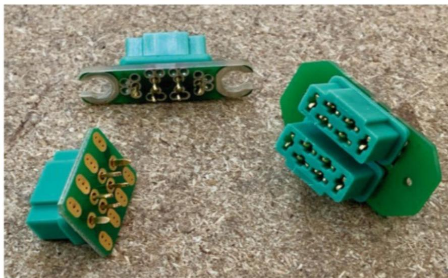
Différentes platines pour prises M6/M8 Multiplex: soudure largement facilitée et fiabilité éprouvée, quand on y a goûté...
