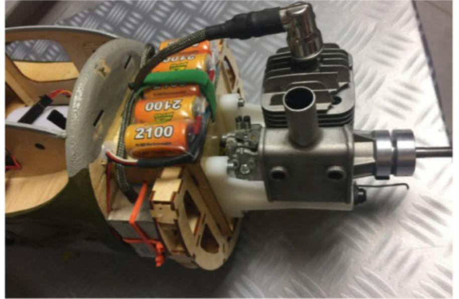
Le DLE 20 cc motorise parfaitement ce Zero : il n'y a pas besoin d'ajouter de masse pour le centrage et la puissance est plus que conséquente.
