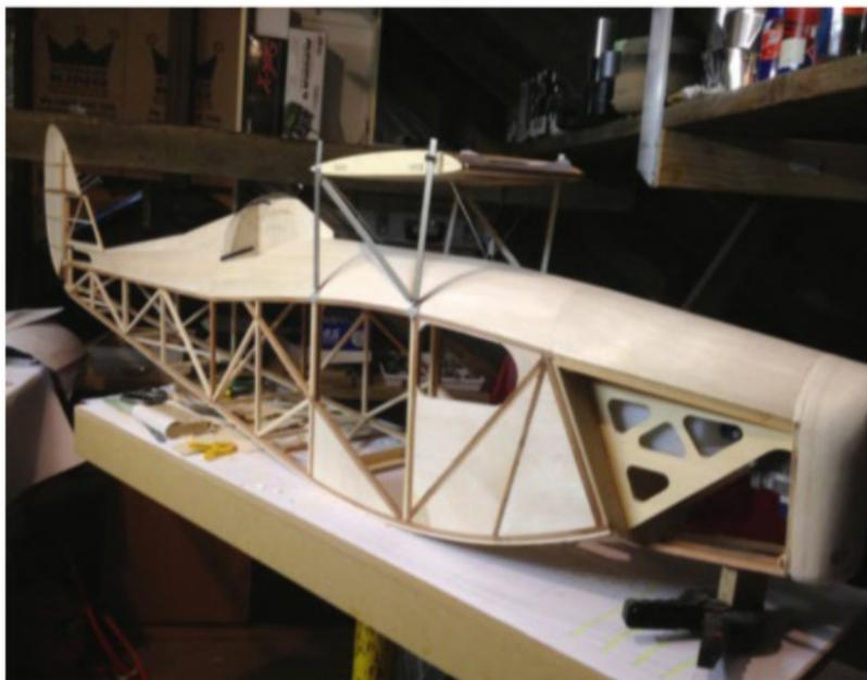
Treillis en pin et balsa constitue la base du fuselage. La partie supérieure du capot moteur est en CTP roulé.
