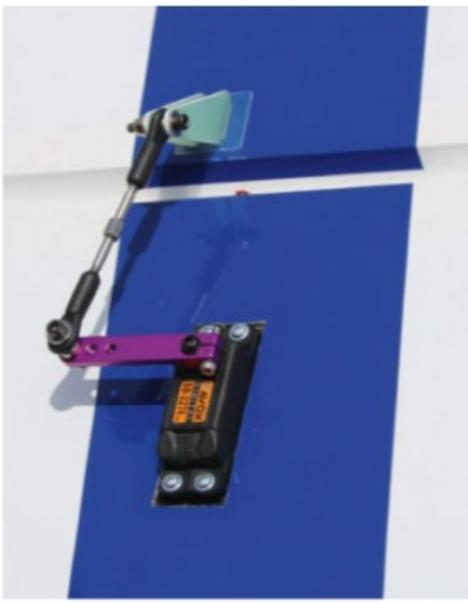
Les palonniers alu sont presque incontournables pour supporter la puissance de ces servos brushless (Savox SB-2274SG HV avec un couple de 25 kg.cm). Les tringleries à pas inversés facilitent les réglages sans démontage.
