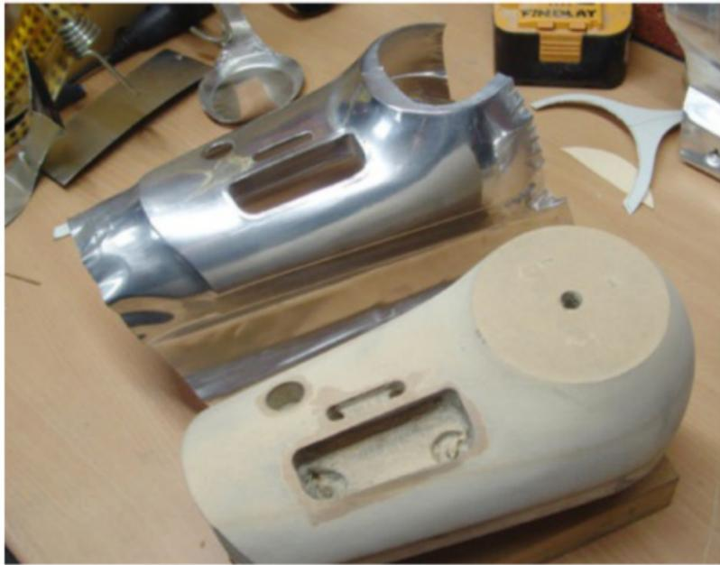
Formage du plastron du capot moteur: un travail compliqué à réaliser. La forme en bois doit être parfaite.
