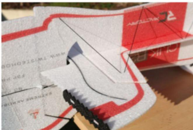
La structure est renforcée par de multiples joncs et longerons en carbone. Cela apporte une très grande rigidité à ce modèle super light.
