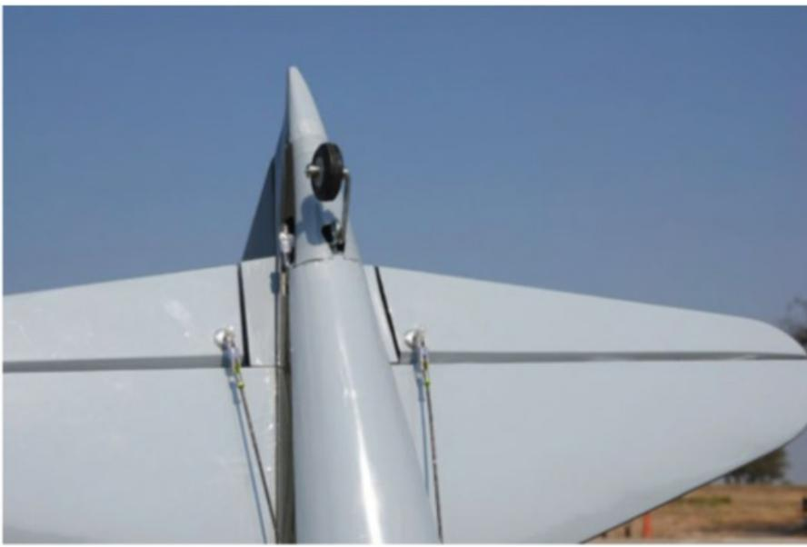
Chaque gouverne de profondeur dispose de sa tringlerie dédiée, les deux étant accouplées dans le fuselage par un domino triple.
