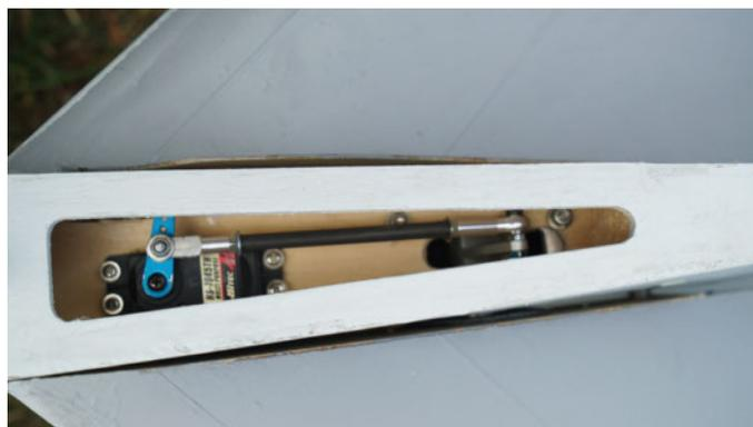
La fonction profondeur est commandée par un unique servo installé dans l'embase de la dérive.
