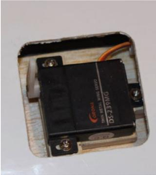
Pour les ailerons, l'auteur a fabriqué des cadres en ctp pour y visser ces servos plat au format 22 g.
