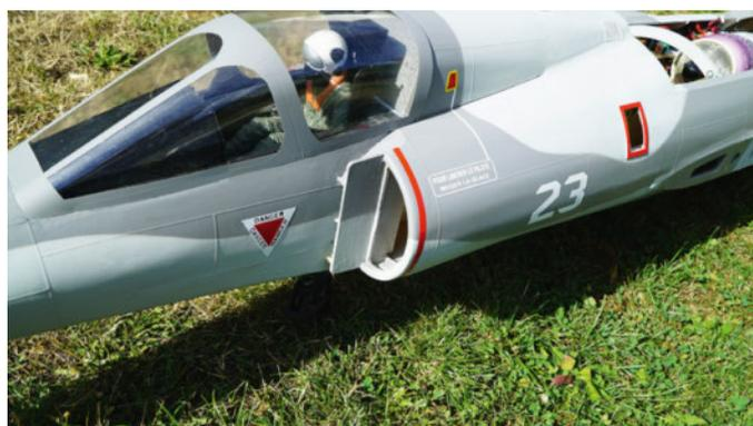
Des bandes autocollantes sont posées avant peinture et simulent les lignes de structure de l'appareil réel.
