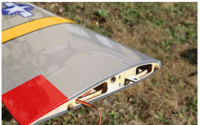
Les nervures d'emplanture sont équipées de platines en contreplaqué permettant de fixer la voilure au fuselage à l'aide de vis.
