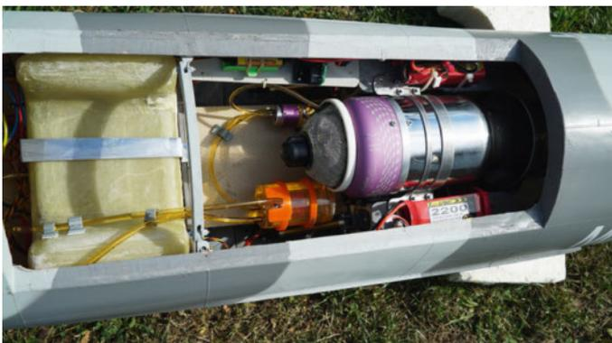
La turbine a une poussée de 14 kg et le réservoir a une capacité de 3 litres. Pour une question de centrage, les accus radio sont installés juste à côté de la turbine.
