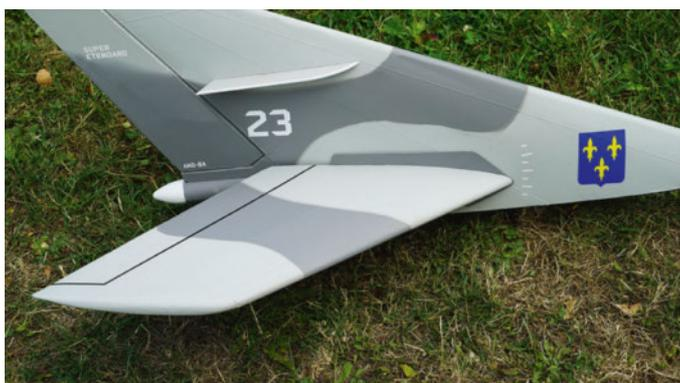
Le stabilisateur est monobloc, comme sur le réel. Il est guidé par deux roulements.
