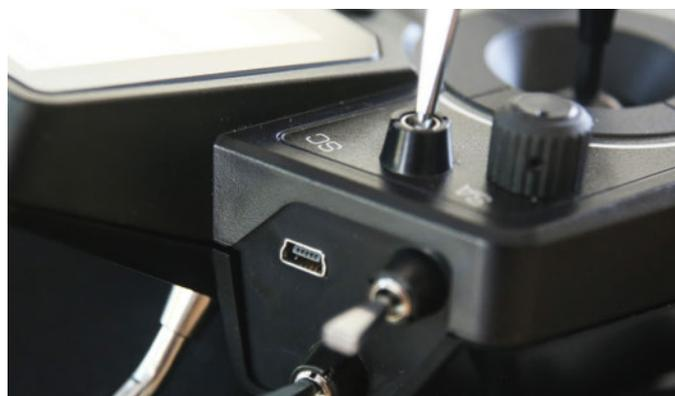
La prise mini-USB permet de connecter la radio à un ordinateur. La DS12 se comporte alors comme un simple disque dur. Les mises à jour se feront via cette connexion.
