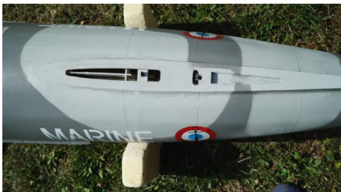
Pour faciliter le transport, la dérive est démontable. Elle est montée sur un gros jonc en carbone.
