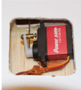
Il y a un servo par aérofrein (ces derniers étant posés d'origine). Ce sont ici des modèles au format 16 g.
