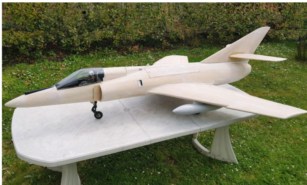
Ce jet est intégralement réalisé en structure bois, et un short kit est disponible chez Maquette Concept.
