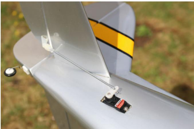
Les servos d'empennage sont fixés à l'extérieur, c'est peu esthétique mais cela permet des commandes courtes et précises.
