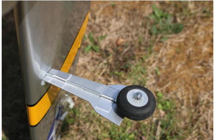
Les jambes de train sont en corde à piano de 3 mm. Ici, elles sont fixes, mais des mécaniques électriques peuvent être installées pour plus de réalisme.
