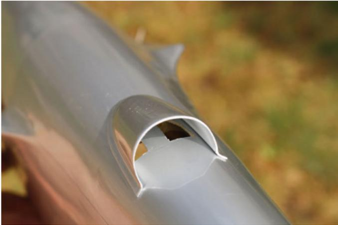
L'air chaud est évacué par une ouverture carénée sous le fuselage, comme sur le Thunderbolt original.
