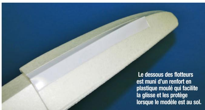
Le dessous des flotteurs est muni d'un renfort en plastique moulé qui facilite la glisse et les protège lorsque le modèle est au sol.
