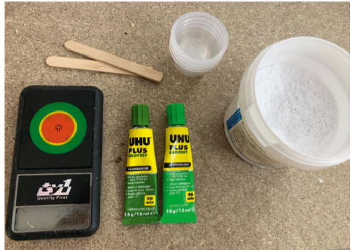
Le matériel nécessaire pour le collage à l'époxy: godet, bâton touilleur, flocc de coton et idéalement une balance de précision pour bien doser la colle et le durcisseur.
