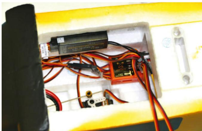
Voici le positionnement du module Reflex et du récepteur dans le fuselage.
