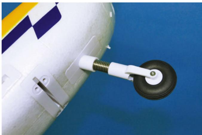
Le train avant breveté par FMS est réputé pratiquement incassable. Il protège parfaitement la cellule. Notez le support de jambe avant des flotteurs.
