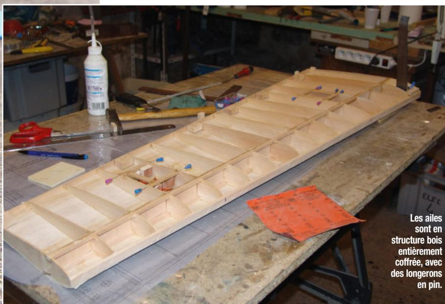
Les ailes sont en structure bois entièrement coffrée, avec des longerons en pin.
