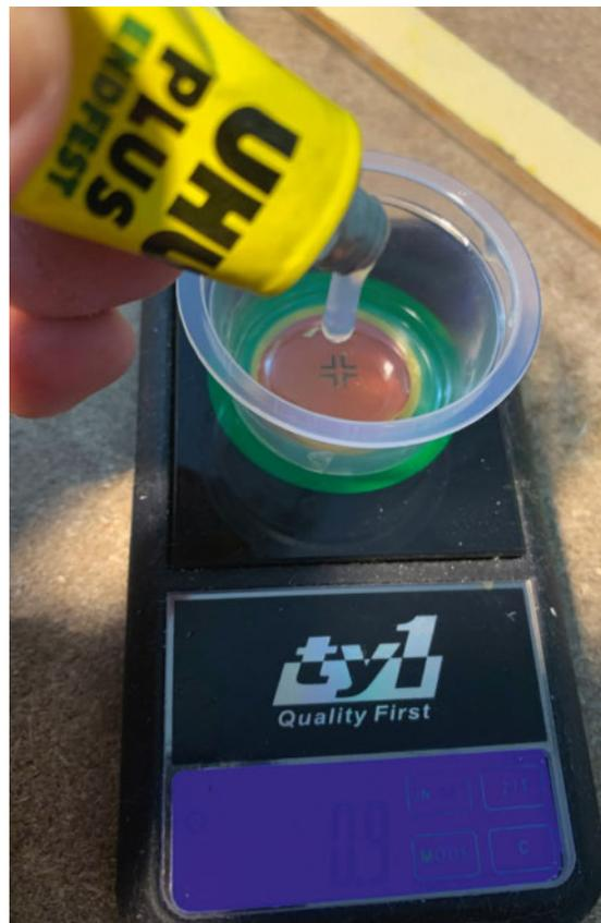
Le problème des petites quantités est qu'un mauvais dosage peut facilement être hors tolérance. Avec une balance de précision, c'est plus simple, et tellement pratique.
