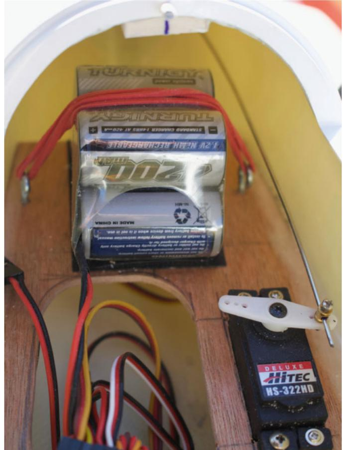
Une platine radio, plus grande, a été refabriquée en ctp. L'accu de réception est un NiMh 6V d'une capacité de 4200 mAh, et il a fallu 170 g de plomb pour le centrage.
