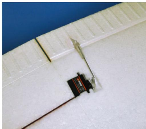
Les servos sont au format 9 g. Ici, un de ceux des ailerons avec une commande bien perpendiculaire à l'axe de rotation de la gouverne.
