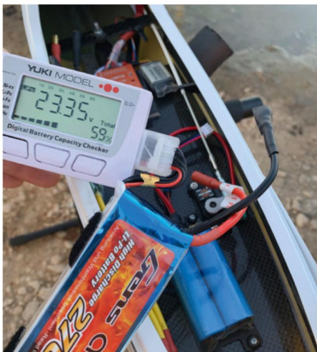
Après une bonne session de vol avec ce planeur de 4 m, il reste encore 59 % dans la LiPo 6S de 2700 mAh. Une montée de 150 m ne prend que 10 secondes, et on peut recommencer quinze fois...
