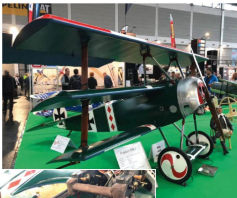
Véritable bijou que ce Fokker DR1 construit par Martin Gertischke. Les détails sont remarquables de réalisme sur cette maquette de 2,37 m d'envergure. La masse est de 15,2 kg et la motorisation est assurée par un 9 cylindres en étoile de 110 cm 3 .
