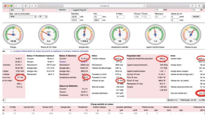
Le logiciel Ecalc : cercles de rouge, les principaux paramètres sur lesquels il faut jouer pour obtenir (en bas à droite) le taux de montée avec la meilleure consommation possible (ici le F3q de l'auteur).
