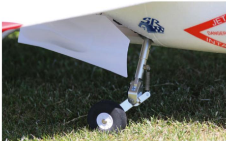
Pour gagner du poids, il ne faut pas hésiter à démonter les superbes jambes amorties pour les remplacer par les cordes à piano fournies. Et on pourra aussi démonter les trappes de train...
