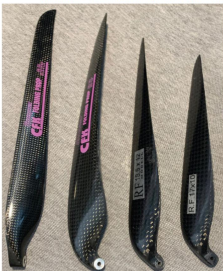
La plus petite hélice est une 17x10 : c'est déjà un beau diamètre, mais c'est le minimum pour obtenir un bon rendement sur un 4 m. Avec les hélices plus grandes, la traction augmente fortement à chaque augmentation de diamètre.
