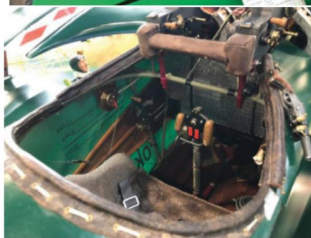
Véritable bijou que ce Fokker DR1 construit par Martin Gertischke. Les détails sont remarquables de réalisme sur cette maquette de 2,37 m d'envergure. La masse est de 15,2 kg et la motorisation est assurée par un 9 cylindres en étoile de 110 cm 3 .
