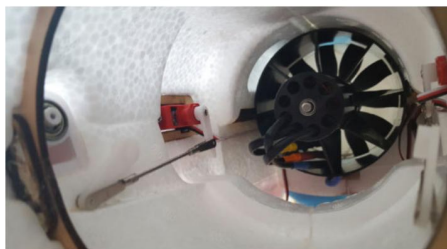
Les servos de profondeur sont positionnés dans le conduit de la tuyère. La turbine de 90 mm de diamètre possède onze pales et le contrôleur est un 120 A.
