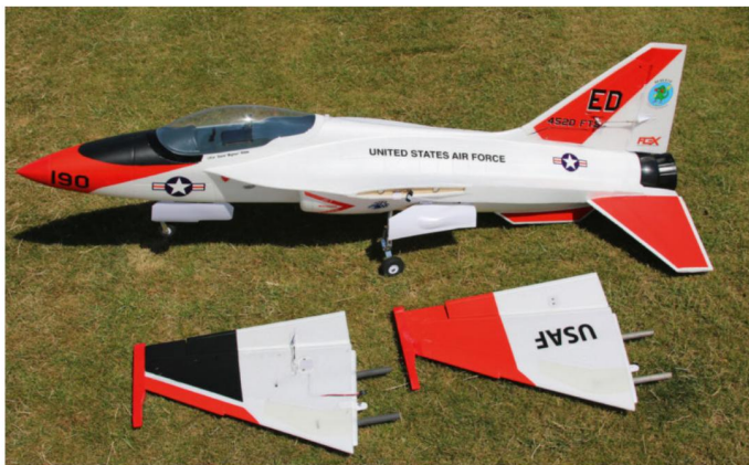
Les ailes sont démontables pour le transport, mais pas le stabilisateur monobloc.
