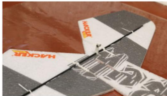
Le stabilisateur est monobloc, sa rotation se fait autour d'un axe carbone faisant également office de longeron. Des pièces en plastique constituent les paliers et le guignol.
