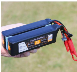
Deux accus LiPo 4S 3650 mAh 90C sont ici couplés en série pour former un 8S.
