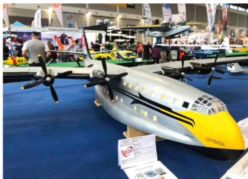
Entièrement construit en Depron (si, si !), ce Dornier 214 présente une envergure de 3,50 m pour une masse de 18 kg. Il est propulsé par huit moteurs brushless : quatre de 700 W et quatre de 300 W. Constructeur et pilote : Franck Seuffert.
