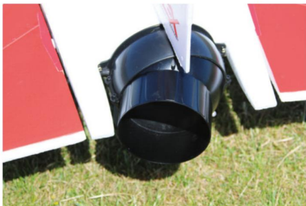
Le vol 3D et les figures « exotiques » sont possibles grâce à la tuyère orientable, commandée par deux servos installés sous le fuselage.
