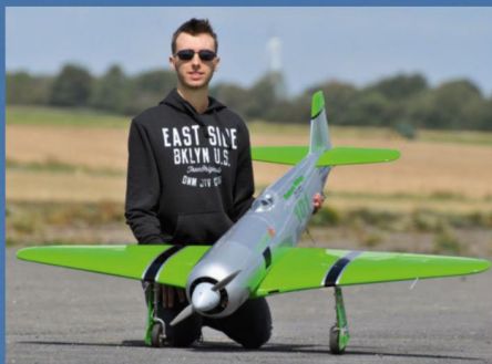
L'oiseau affiche 1,80 m d'envergure, et ses ailes en deux parties facilitent le transport.
