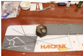
Inhabituel : les ailerons sont tellement grands que le fabricant a prévu de les haubaner pour leur donner plus de rigidité !
