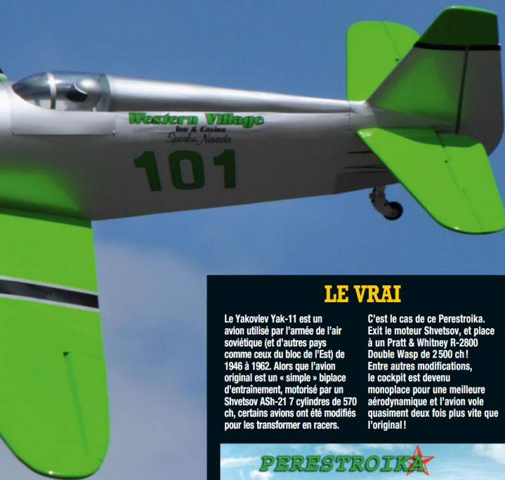
L'oiseau affiche 1,80 m d'envergure, et ses ailes en deux parties facilitent le transport.
