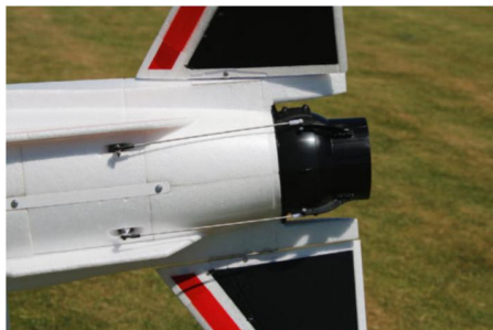
Le vol 3D et les figures « exotiques » sont possibles grâce à la tuyère orientable, commandée par deux servos installés sous le fuselage.
