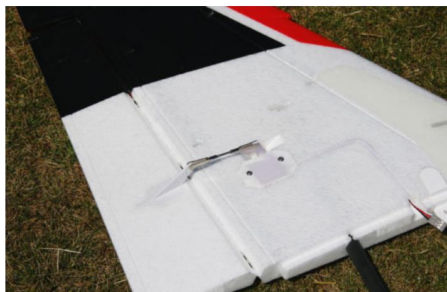
Les ailes sont équipées d'ailerons, mais pas de volets. Les servos sont des numériques à pignons métal.
