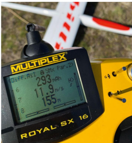
Un taux de montée de 12 m/s avec le Hacker A40 10S V2 réducteur pour ce planeur de 4,7 m d'envergure (hélice 23x12).
