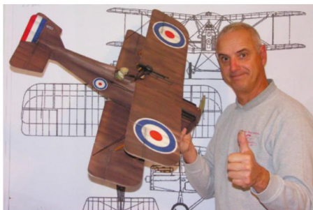
83 cm d'envergure pour 300 g, et une charge alaire de 11 g/dm² pour ce SE5a.
