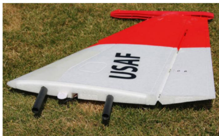
Ces ailes sont reliées au fuselage avec deux clés en carbone qui coulisent directement dans la mousse. Le profil est un biconvexe assez fin, à 8,2 %.
