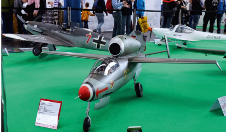
Ce Me162 « Salamander » à l'échelle 1/4 affiche une envergure de 2280 mm. Il est motorisé par une turbine électrique de 128 mm alimentée par un accu LiPo 14S 16000 mAh, soit 52 V !
