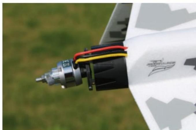
Les fils du moteur sortent en dessous et il faut laisser suffisamment de « mou » pour garantir les mouvements du moteur.
