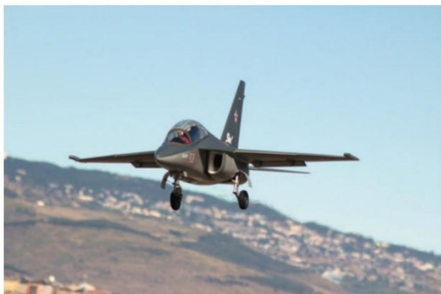
Dorian Coquaz est venu avec ce Yak-130 Jet Legend au 1/4. L'envergure est de 2,39 m, la masse de 24,5 kg, et la motorisation est assurée par une unique turbine Kingtech K210 avec tuyère en Y.
