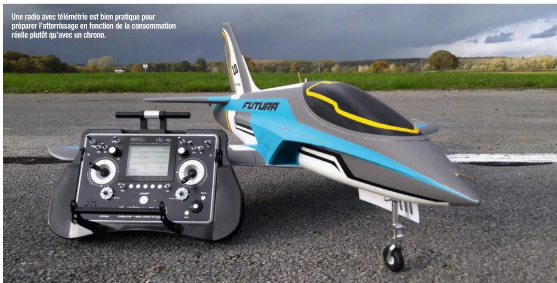
Une radio avec télémétrie est bien pratique pour préparer l'atterrissage en fonction de la consommation réelle plutôt qu'avec un chrono.
