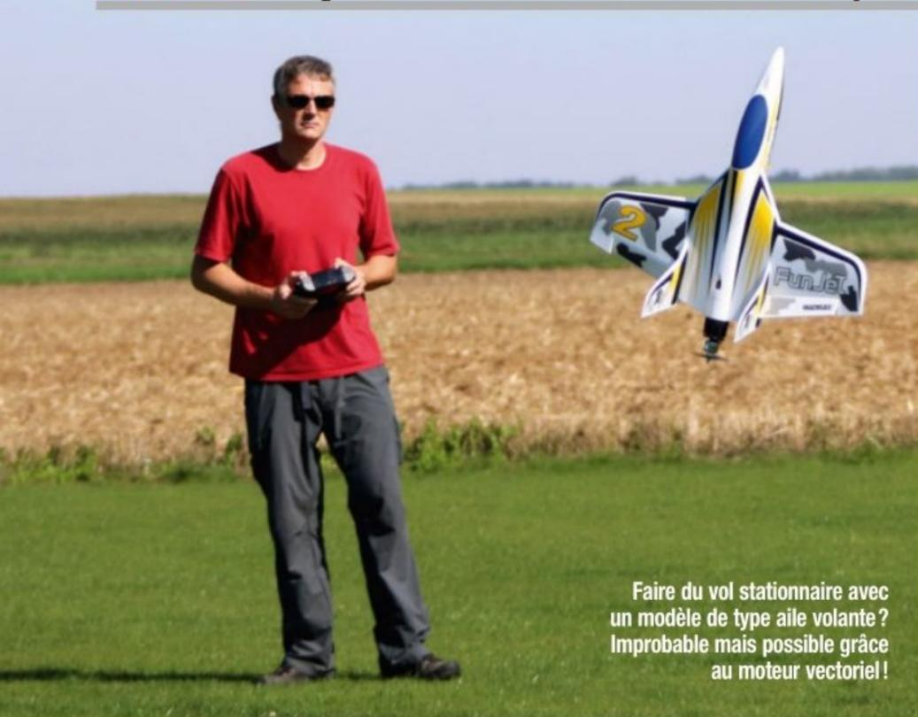
Faire du vol stationnaire avec un modèle de type aile volante ? Improbable mais possible grâce au moteur vectoriel !
