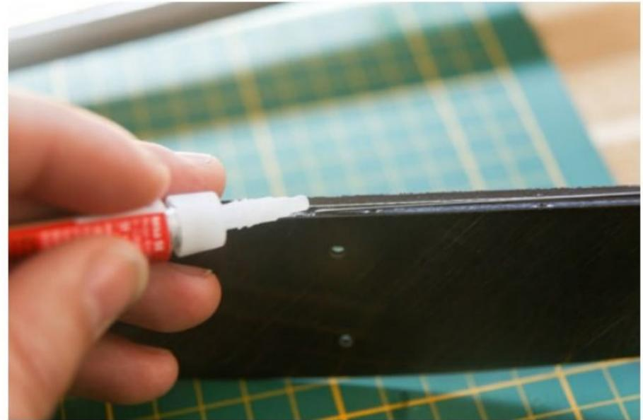
Pour les ressorts de commande, une goutte de cyano permet de renforcer la fixation des cordes à piano sans ajout de poids.
