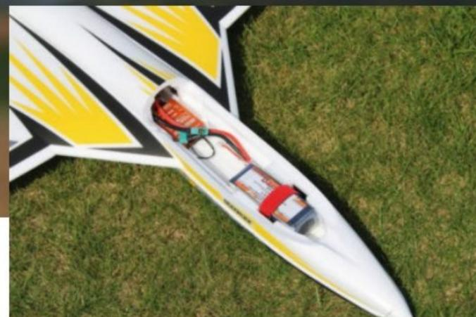
L'accu sera un LiPo 3S avec une capacité de 1800 à 2200 mAh, installé tout à l'avant.
