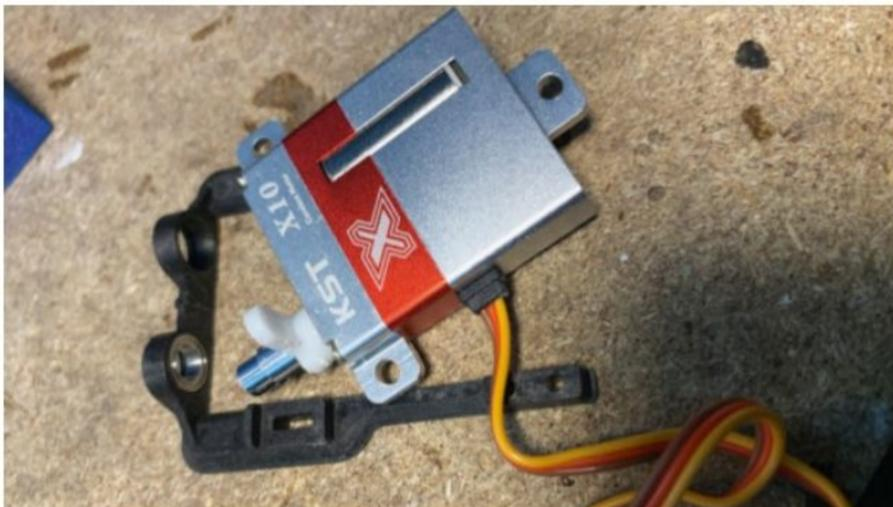
Cadre sans système LDS mais avec roulement, pour soulager les contraintes sur la tête de servo.
