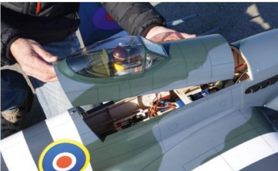
Avec une tirette à l'arrière et deux tenons à l'avant, la bulle se retire très rapidement et assure un accès optimal.
