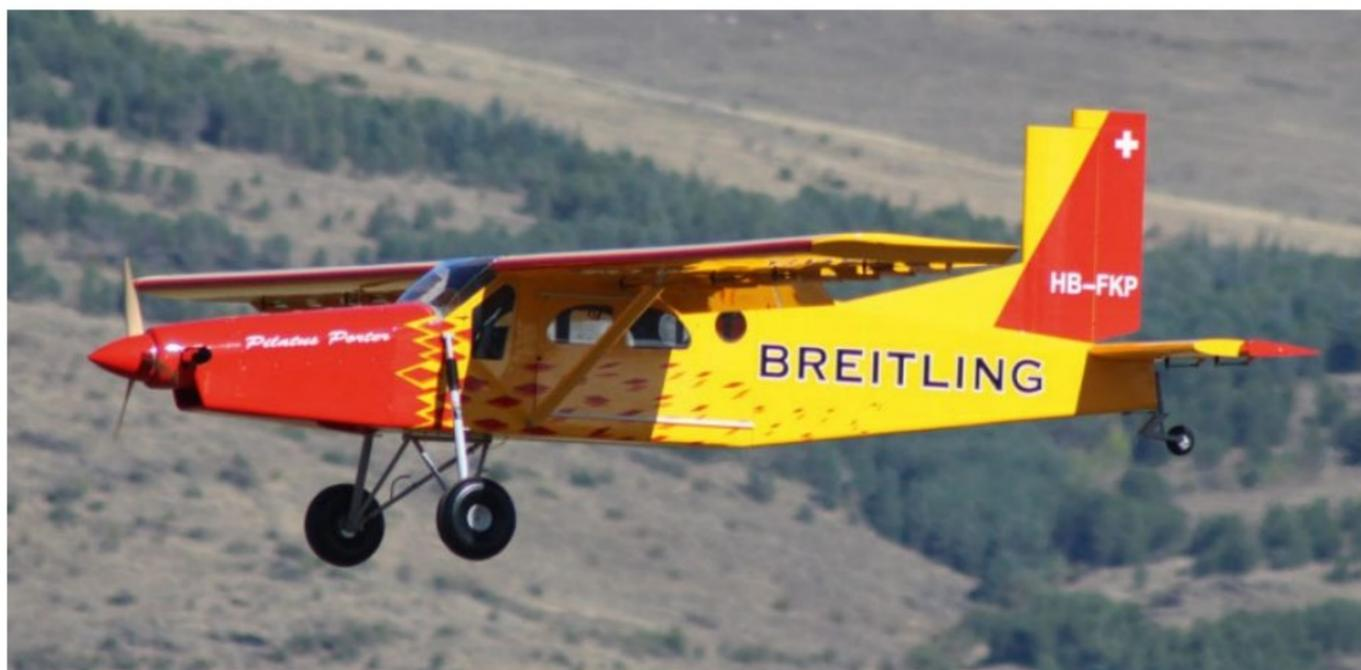
Les turbopropulseurs étaient bien évidemment de la partie. Javier Izquierdo paraît bien petit à côté de son monstrueux Pilatus PC6 à l'échelle 1/3. La motorisation est assurée par un Kingtech TP100. Envergure 5,29 m, masse 45 kg.
