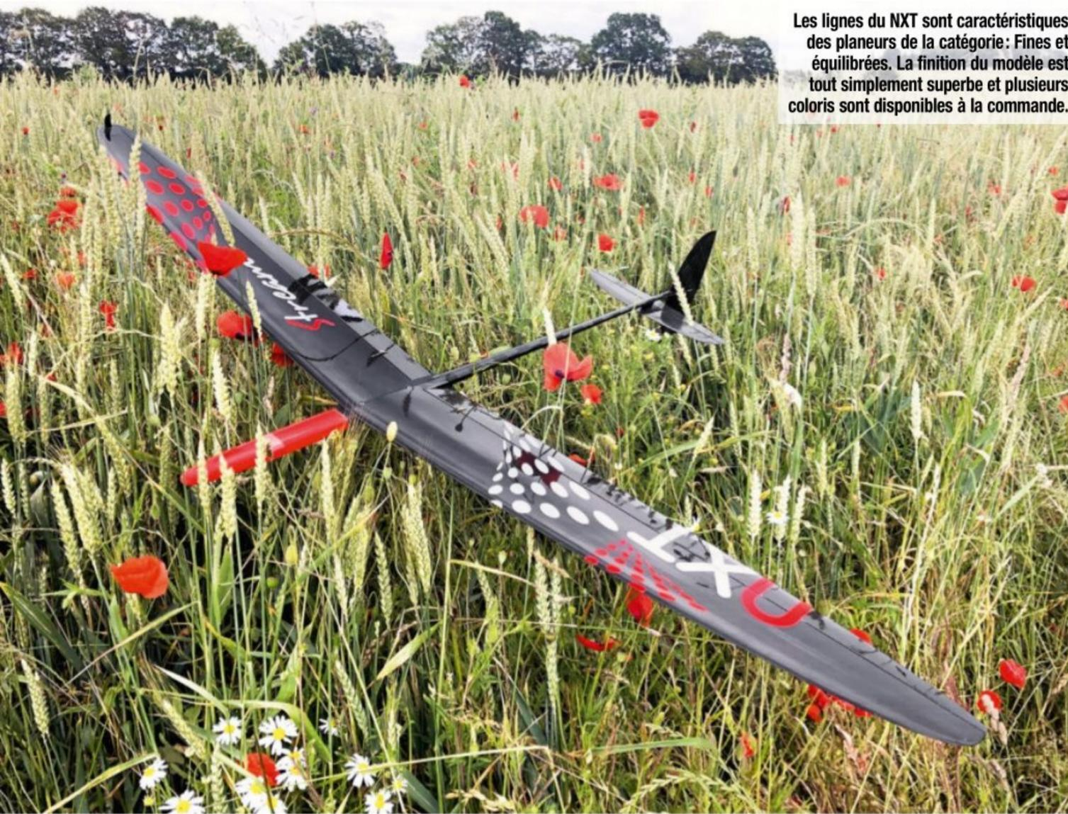
Après avoir ajusté le centrage, l'accu est chargé, direction le terrain. Le premier lancer se fait en mode javelot. Certes, la prise en main sous le fuselage n'est pas très confortable, mais il s'agit d'un lancer de réglage. Le NXT se montre fin et bien réglé. Il ne m'a pas fallu un seul cran de trim, démontrant que tout est parfaitement aligné.
