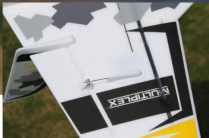
Les élévons sont articulés par la mousse et les servos sont des Hitec HS-65 HB, rentrés en force dans leur logement.
