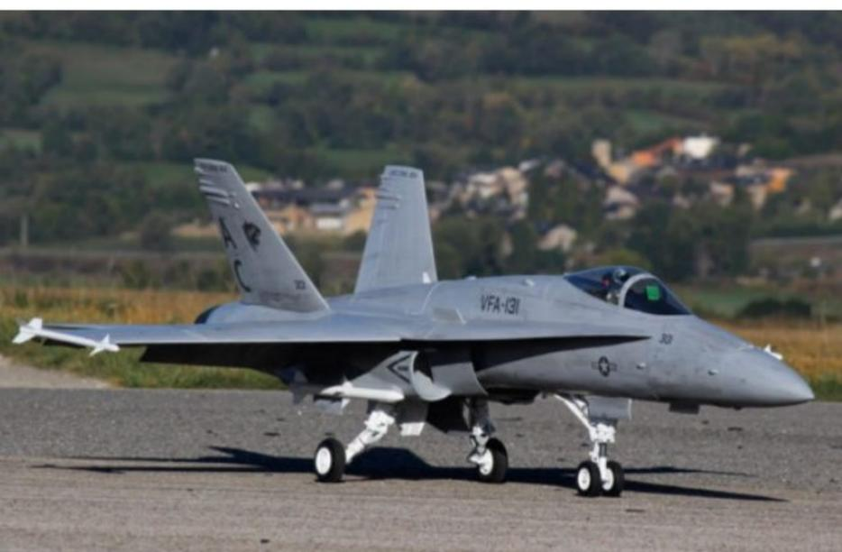
Assez rarement reproduit en jet, ce superbe F-18 C Hornet est un kit d'origine Skymaster et appartient à Arnaud Sense. Il est animé par deux turbines Merlin 200 et affiche une masse de 33 kg. Échelle: 1/5,75.
