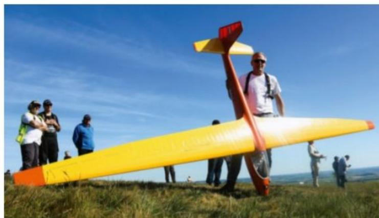
Le Ka 6 E d'Antoine Violette faisait ses premiers vols au Menez. L'envergure est de 5 mètres pour 10 kg sur la balance. Les ailes sont en structure, le fuselage en fibre de verre.
