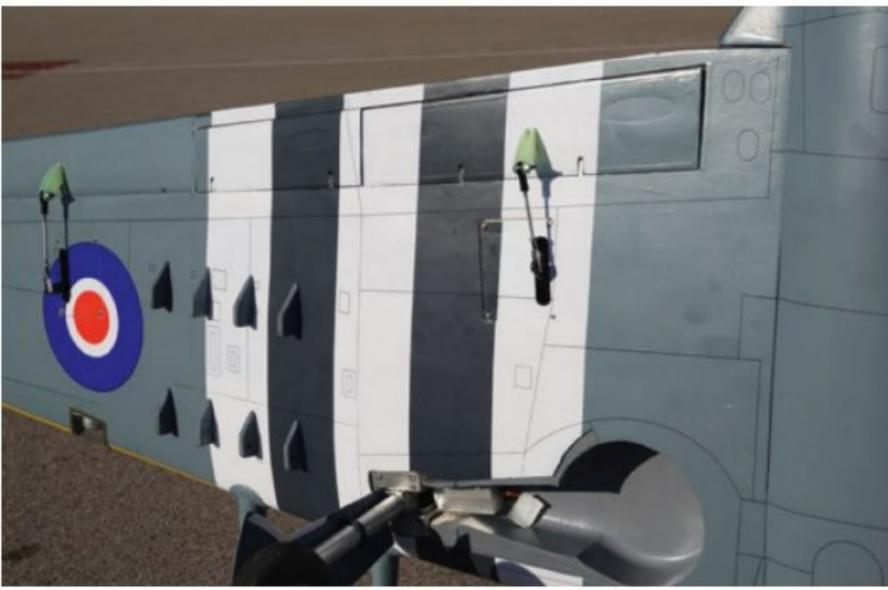
Le train pneumatique fourni dans le kit a été remplacé par un train électrique, par choix de l'auteur. Les servos de volets et d'ailerons sont discrètement logés dans l'épaisseur du profil.
