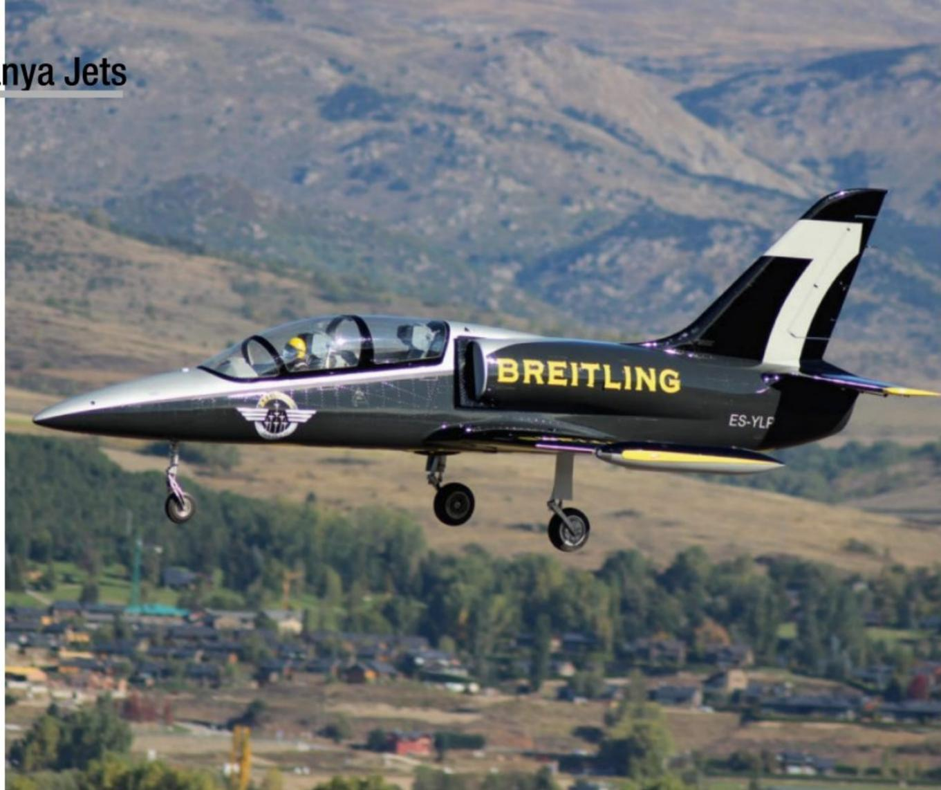
Cet énorme L.39 XXXL Tomahawk Aviation appartient à Jean-Michel Besnard et est piloté par Franck Corbet. À l'échelle 1/ 2.7, il est motorisé par une turbine JetCat P550 de 55 kg de poussée (pour un avion qui en pèse 80) et nous a gratifiés d'un superbe vol au crépuscule, avec dispositif lumineux et lâcher de leurres.
