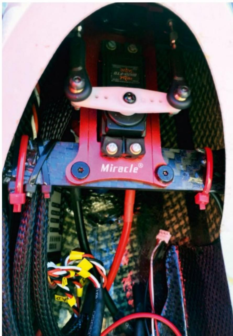
Une commande par câble A/R très sérieuse, issue de la VGM, pour ce planeur lourd de voltige. Notez sa position haute pour laisser le passage au pack d'accu en dessous.
