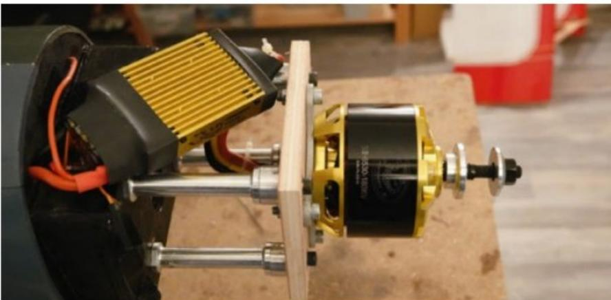
Au départ, l'auteur avait prévu de monter un moteur 33 cc essence. Mais vu le plomb nécessaire au centrage (1,5 kg), il a préféré mettre un gros brushless et un accu LiPo 12S 5000 mAh qui permettent d'obtenir un centrage sans lest.
