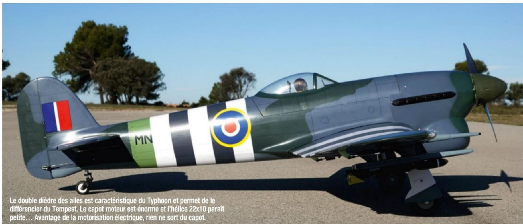
Le double dièdre des ailes est caractéristique du Typhoon et permet de le différencier du Tempest. Le capot moteur est énorme et l'hélice 22x10 paraît petite... Avantage de la motorisation électrique, rien ne sort du capot.
