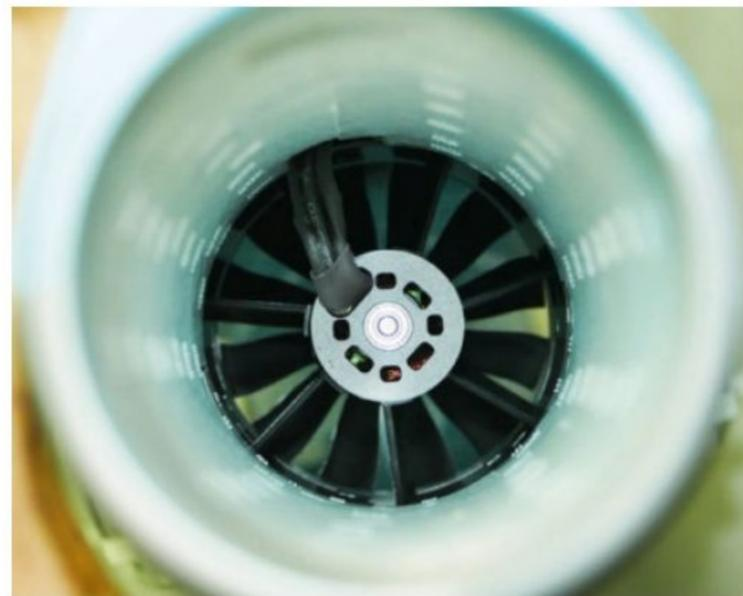
La turbine de 80 mm à 12 pales est visible par les entrées d'air ou la tuyère. Et elle pousse fort ! En cas de besoin, une trappe permettra d'y accéder.
