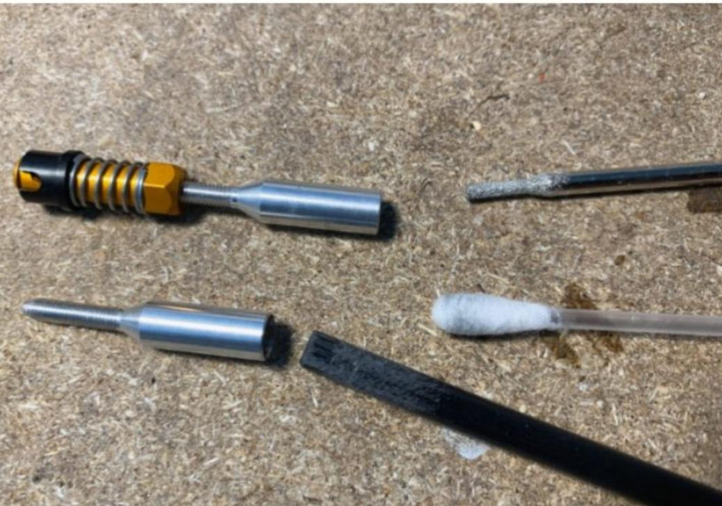
Toutes les surfaces de collage doivent être dépolies et dégraissées avant d'être collées à l'époxy lente. Aucune erreur n'est permise sur la profondeur!
