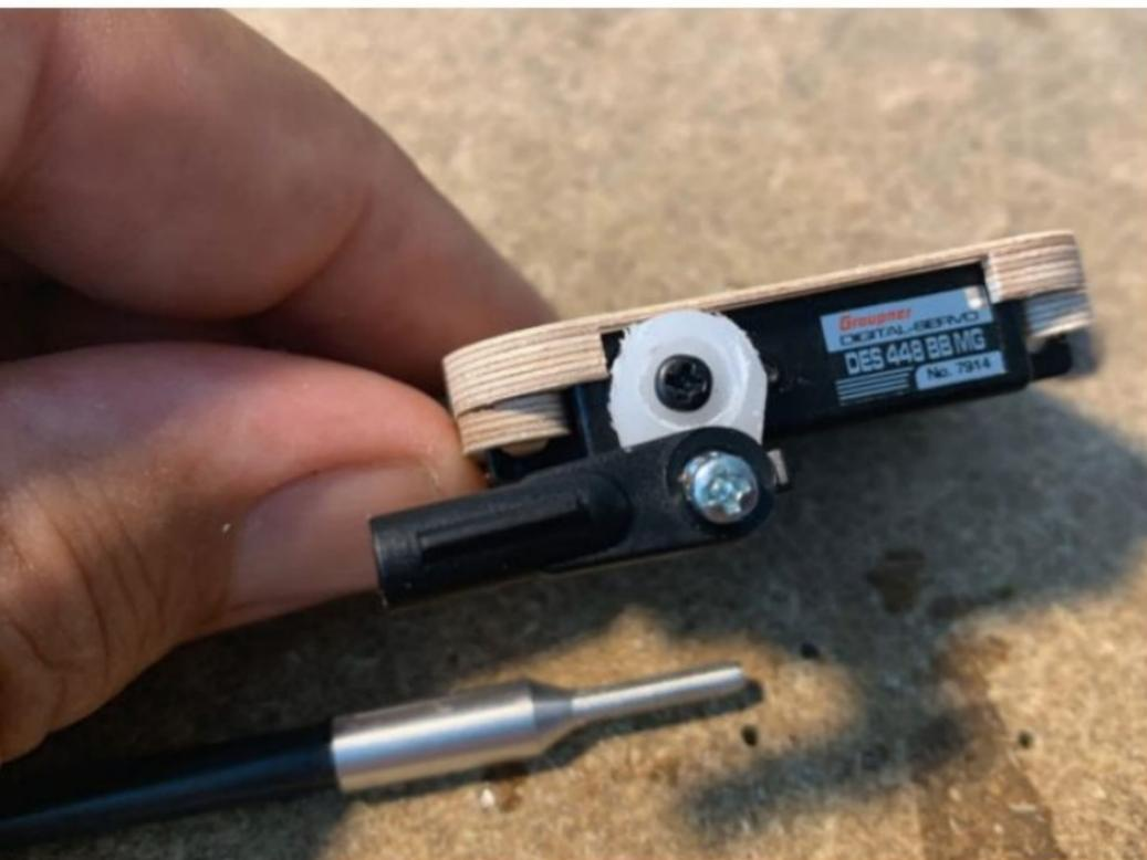
Servo sans jeu sur cadre, chape de 3 mm pour la profondeur du Finesse Max de 4 m (stab à volet).
