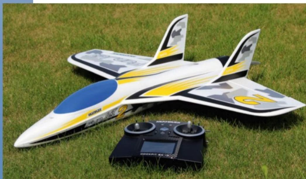
Plus légère mais moins rigide que la Funjet Ultra, la Funjet 2 peut être montée avec une motorisation classique ou, comme ici, avec le moteur vectoriel, c'est-à-dire installé sur un support articulé et commandé par deux servos.
