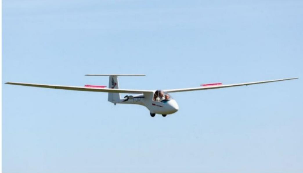
Le DuoBanjo de Gérard Prat est original à plus d'un titre. Ce moto-planeur de 4 mètres pour 5,5 kg ne ressemble à aucun autre et profite d'une propulsion électrique, bien pratique en ce samedi du fait de conditions difficiles (vent de travers). Le profil est identique à l'original, soit un FX 60 126. Le fuselage est en fibre, les ailes sont coffrées et l'échelle est au 1/4.
