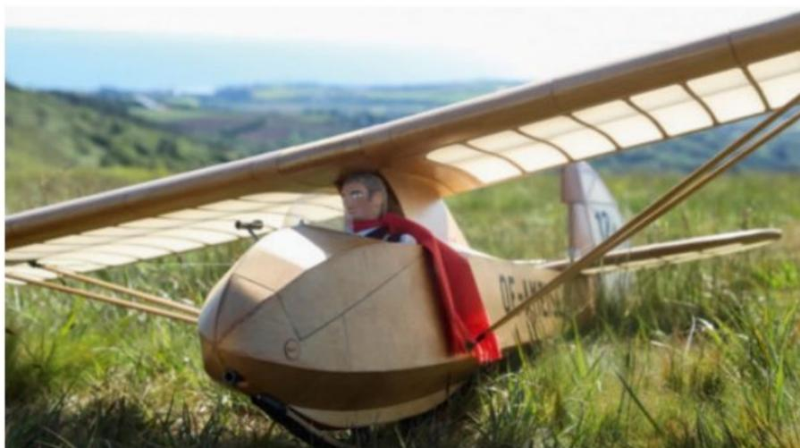
Le Musger Mg12 A de Michel Malabat est un exemple de perfection. Michel aura mis un an et demi pour le terminer. Le fuselage est composé de cadres et de baguettes en pin 4x4. Quant au coffrage, il est réalisé en CTP 6/10°. Pour l'anecdote, les cheveux du pilote sont ceux de Michel. Quand on aime!
