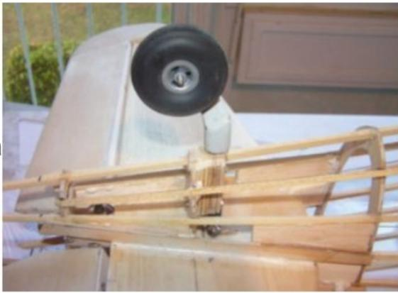
Cela passe par le futur câblage, le passage des éventuelles tringles, l'implantation des servos, le positionnement du réservoir, bref, une vraie étude sur les plans est nécessaire. Le but est de « rentabiliser » chaque pièce afin de produire un avion léger. Il faut également que la moitié de fuseau construite sur le chantier soit la plus grande possible, cela limite les risques de léger vrillage lors du « démoulage ».
