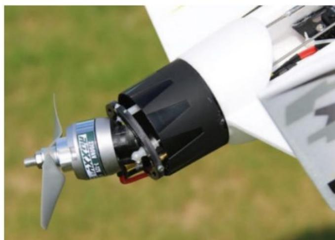
L'option vectorielle proposée par Multiplex comprend un support articulé sur deux axes, un moteur spécifique et deux servos qui commandent l'orientation du moteur.
