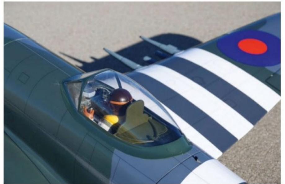
La bulle est à coller, alors que l'aménagement du cockpit est en place (il ne reste que le pilote et le manche à balai à installer).
