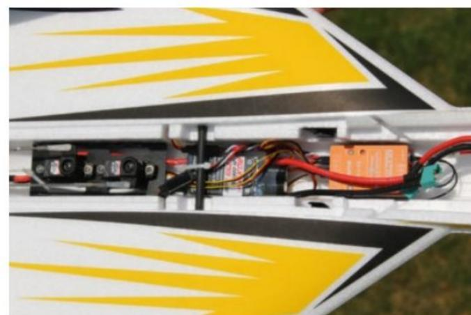
De gauche à droite: les deux servos qui commandent l'orientation du moteur, le contrôleur 55A et, en orange, le Wingstabi RX-7-DR qui fait office à la fois de gyroscope et de récepteur 7 voies.
