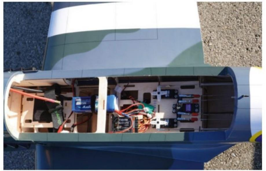
L'accu LiPo 12S 5000 mAh (non visible ici) sera installé le plus possible à l'avant. Au centre, on voit les deux accu LiPo 2S pour le récepteur (couplés à un régulateur de tension). Il y a un servo par gouverne de profondeur, et un unique servo pour la dérive et la roulette de queue.
