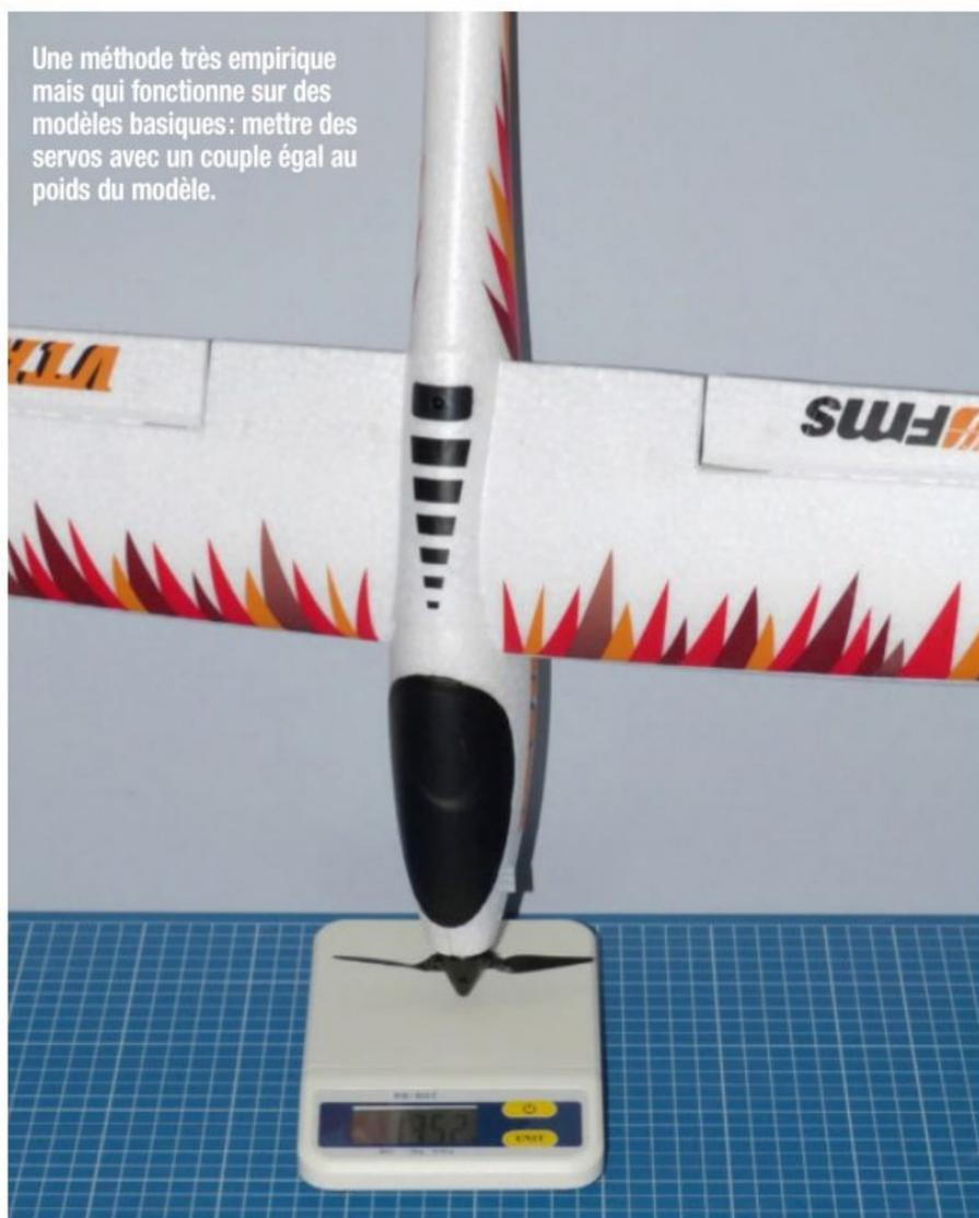
**Couple de service = largeur (m) x longueur (m) x V<sup>2</sup> (m/s) x angle (°)**
