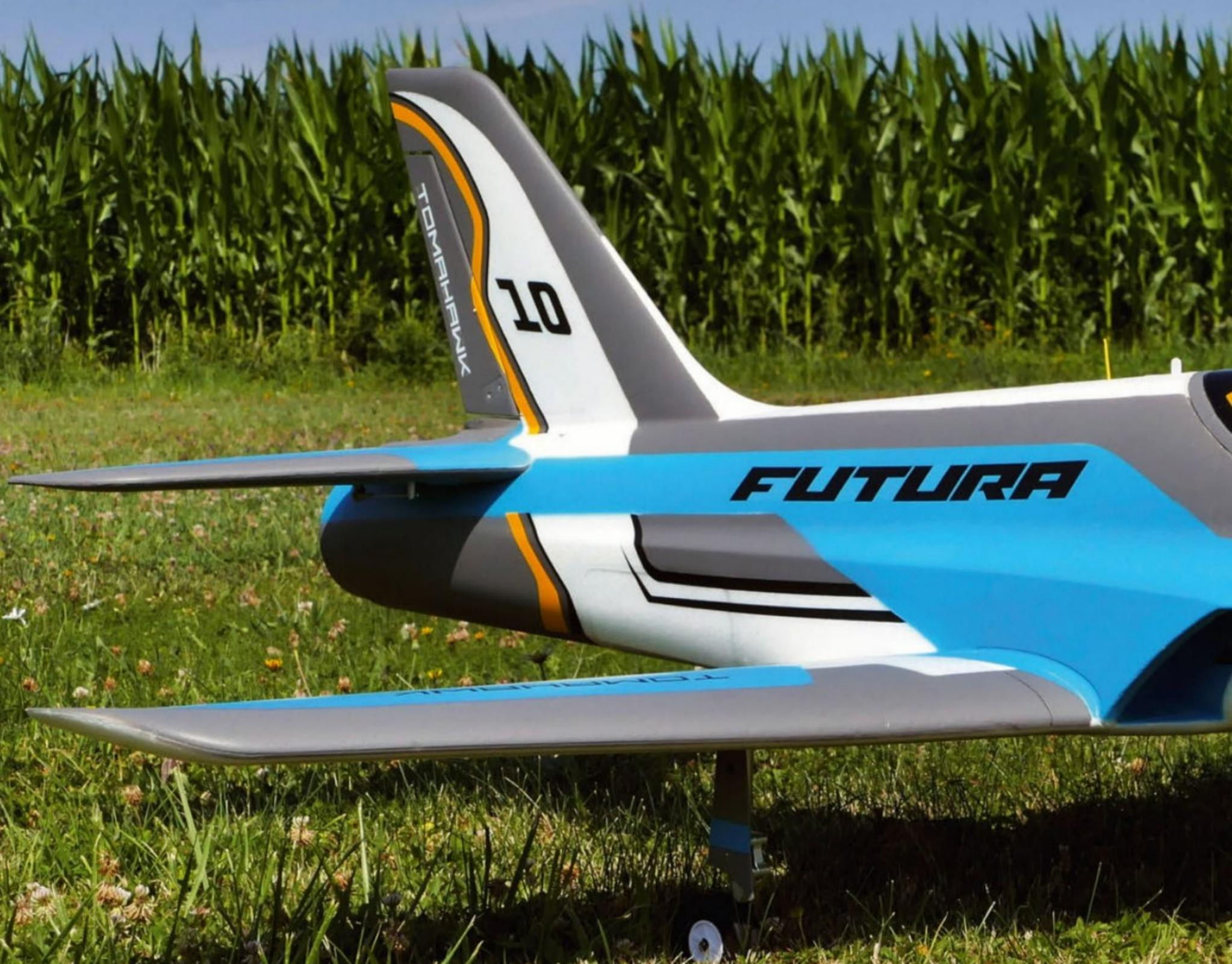
**L**e Futura originel est un jet « à réacteur » conçu par Tomahawk Aviation et adapté à une voltige assez proche du F3A, tendue et ultra-précise. Il est disponible en 1,90 et 2,60 m d'envergure.
