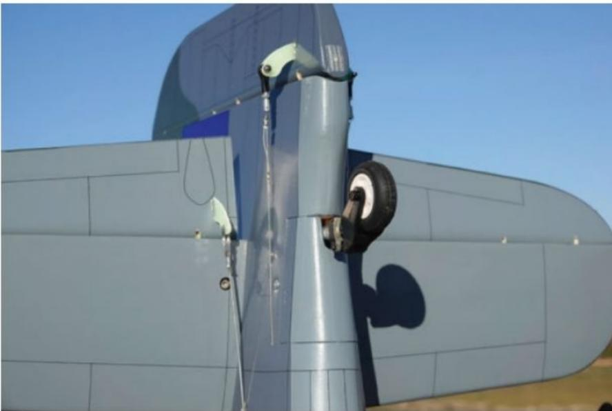
La fixation de la roulette de queue est dissimulée sous un capot et l'accès n'est pas facile. Les guignols sont en fibre de verre et le stabilisateur en deux parties reste démontable pour le transport et le stockage.
