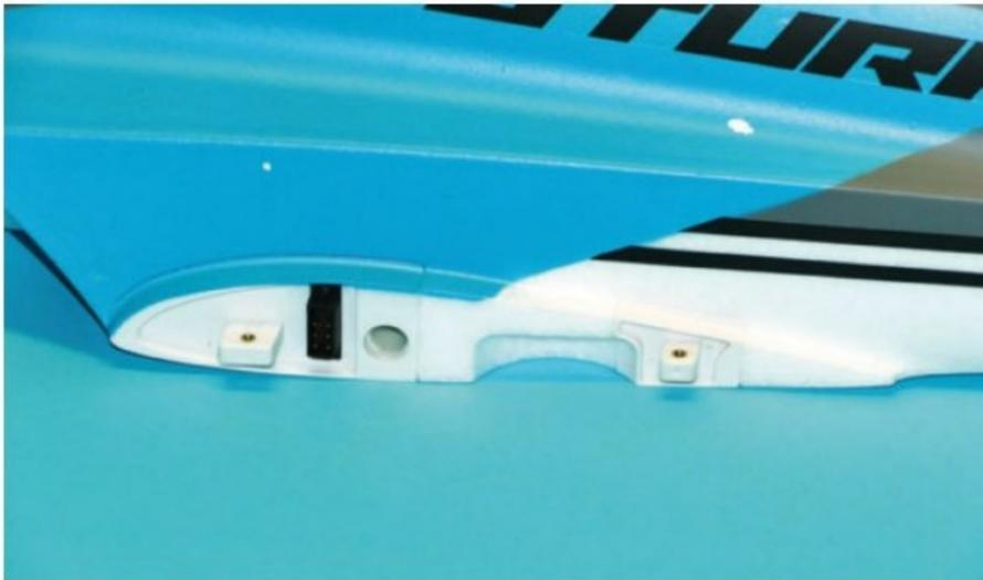
Le raccord fuselage-ailes et ses ergots servant à caler l'incidence et recevant les vis de fixation des demi-voilures. On voit aussi (en noir) le multiconnecteur pour les servos d'ailerons, de volets et le train.
