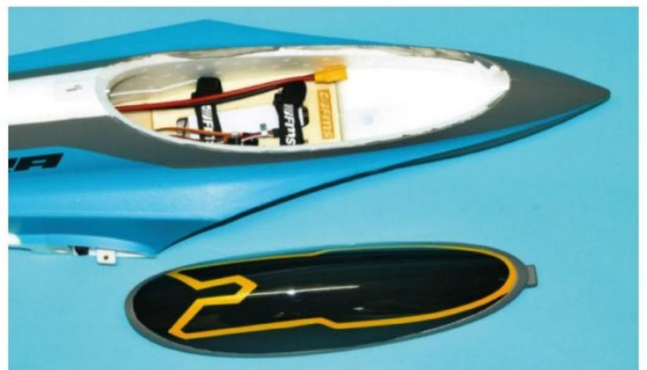
La bulle se retire facilement et le volume réservé à l'accu LiPo 6S 4000 mAh est conséquent.
