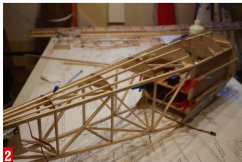
plancher pour recevoir le réservoir, puis un autre pour le support servo de direction et le récepteur. Quant au servo de profondeur, le manque de place et la complexité d'une commande double par câbles aller-retour difficilement
