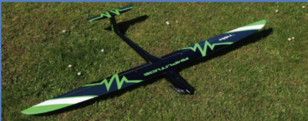
Ce modèle est entièrement en fibre de verre avec des renforts en carbone et sa qualité de moulage est superbe. L'état de surface « miroir » est parfait, avec une peinture réalisée dans le moule.
