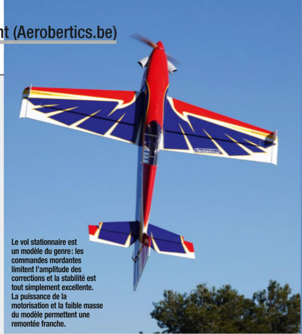
Le vol stationnaire est un modèle du genre : les commandes mordantes limitent l'amplitude des corrections et la stabilité est tout simplement excellente. La puissance de la motorisation et la faible masse du modèle permettent une remontée franche.
