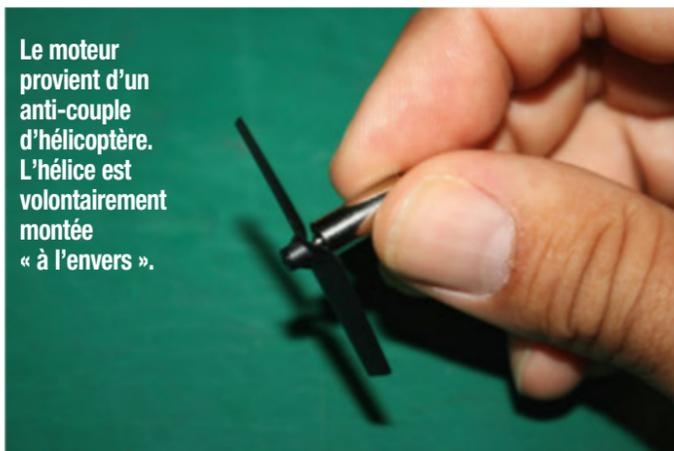
Le moteur provient d'un anti-couple d'hélicoptère. L'hélice est volontairement montée « à l'envers ».
