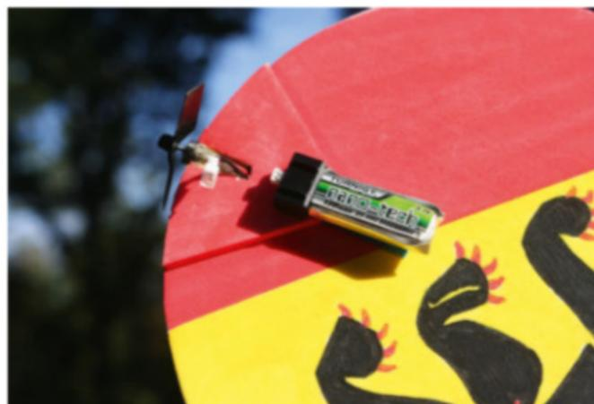
La batterie LiPo 1S de 130 mAh (maxi) est tenue avec du Velcro sous le modèle.
