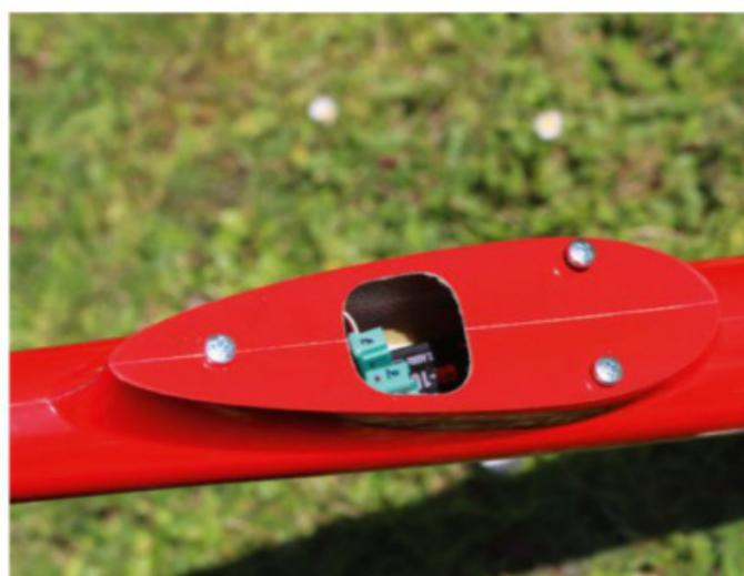
Les ailes sont fixées au fuselage sur un pylône, à l'aide de trois vis M4.
