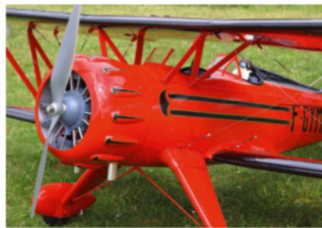
tube Pitot, haubanage des ailes, forme de la dérive, déco, etc. Le moteur est un brushless Dualsky Eco 4130V2, le contrôleur est un 100 A et l'accu un LiPo 6S 5000 mAh. Le modèle est à l'échelle 1/5.7, mesurant 1,60 m d'envergure et pesant 5,3 kg.
