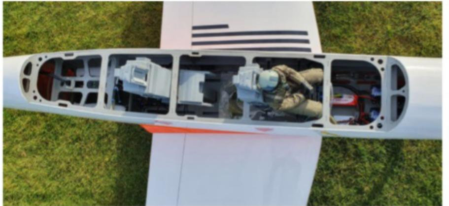
La grande bulle offre un accès idéal à l'intérieur du fuselage. On regrettera juste sa fixation avec quatre vis M3, qui n'est pas très rapide à mettre/enlever.
