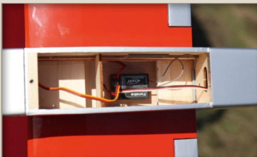
Une large trappe est présente sous le Chico et permet d'accéder au compartiment radio, dans lequel seul le récepteur est installé.
