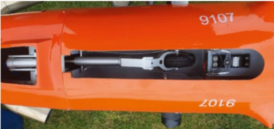
La jambe de train avant, son servo de direction et les câbles de commandes : un collier en plastique est placé en arc de cercle entre les câbles pour les guider.
