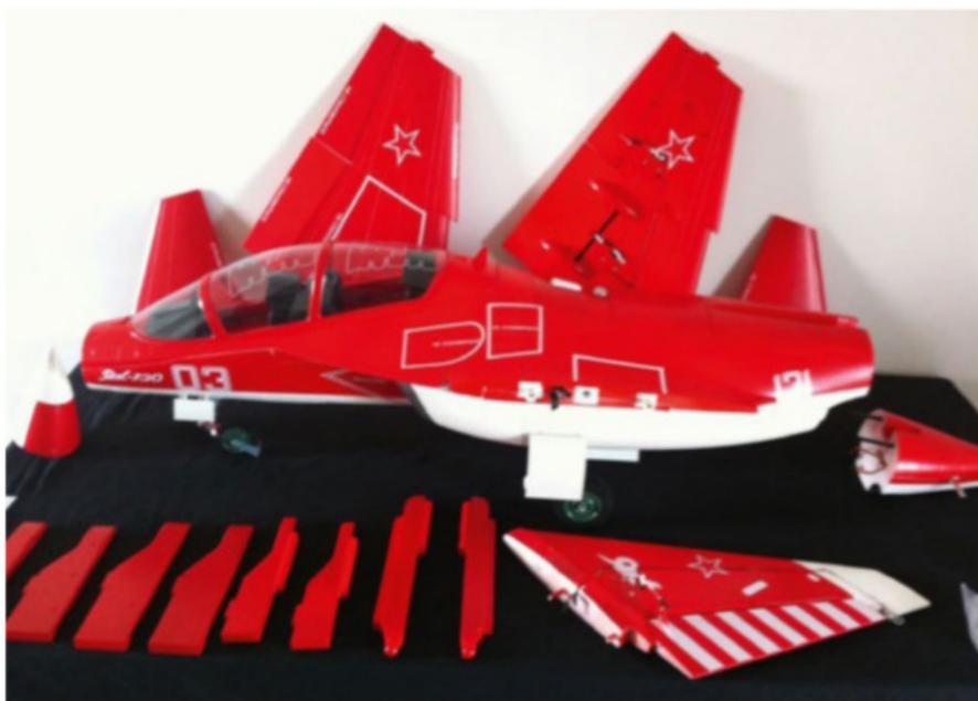
hypersustentateurs se fait par le biais d'un tube carbone incrusté dans l'aile et de biellettes alu qui agissent comme des volets fowler. Superbe! Les ailes sont glissées sur deux tubes en carbone sur le fuselage et immobilisées par quatre vis 4x8mm dans deux inserts en plastique, eux-mêmes déjà incrustés dans les ailes: pratique car démontable si on n'a pas le véhicule approprié. Avant de fixer complètement les ailes, on connecte les fiches des
