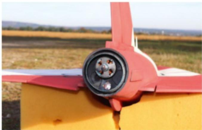
Point de turbine électrique ici, mais un simple petit moteur brushless monté en propulsif avec une hélice (démontée pour cette séance photo). On voit, sous le moteur, la grosse led qui simule la postcombustion...
