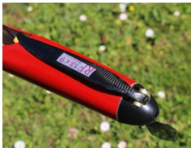
Un cône de 38 mm vient coiffer l'avant du fuselage, il est ici équipé d'une paire de pales carbone RFM 13X9.
