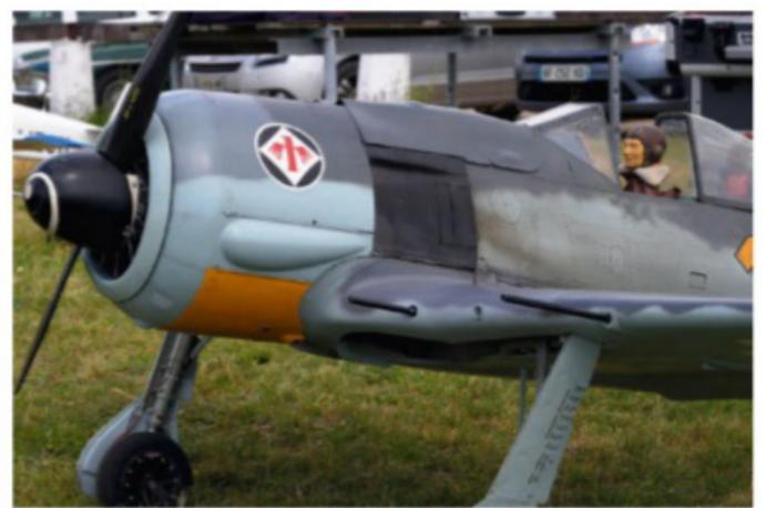
un Saito FG84 R3. Le train rentrant est un Sierra Giant (marque bien connue aux US) et les jambes de trains ont été maquetisées pour être conformes au réel. La roulette de queue fonctionnelle
