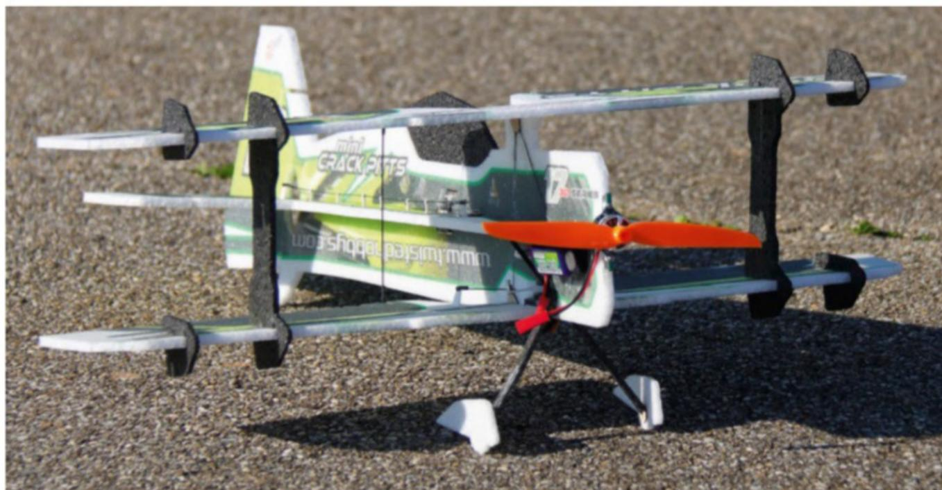
Intégralement réalisé en EPP et renforcé avec des joncs en carbone, ce voltigeur devrait bien résister aux chocs...
