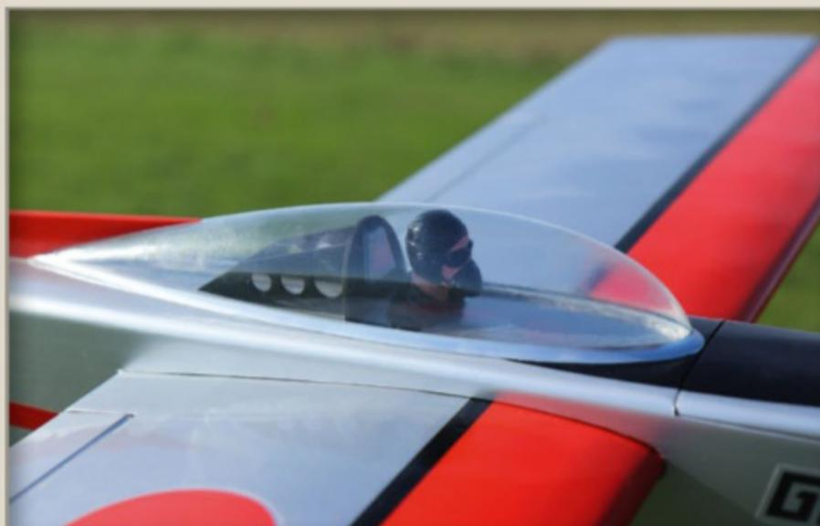
La verrière a reçu une embase « maison » en contreplaqué pour faciliter et renforcer le collage. Un buste de pilote (non fourni) est installé et une couche de peinture est appliquée sur l'encadrement.
