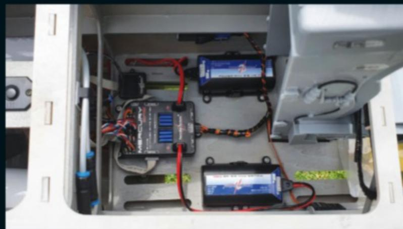
*La partie radio est alimentée par une PowerBox Mercury : un produit fiable, performant, qui permet d'utiliser deux récepteurs pour une totale redondance et avec un gyroscope intégré. Les accus PowerPak sont très pratiques avec leur chargeur intégré.*
