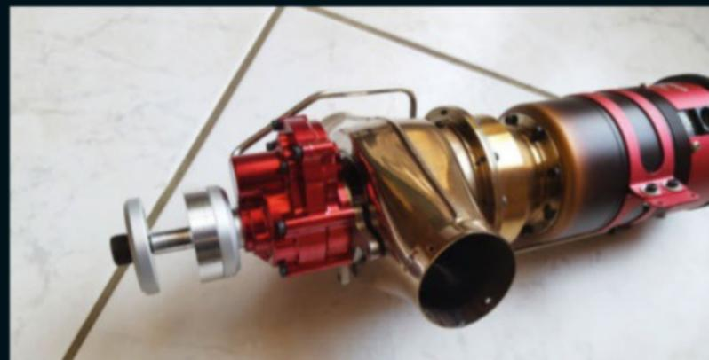
*C'est un petit Kingtech TP-45 qui motorise vaillamment ce gros modèle. Il a une puissance de 5,2 kW (environ 7 chevaux) et la traction disponible avec l'hélice 5 pales 20x10 est étonnante. On voit ici, en rouge, le réducteur du turboprop.*
