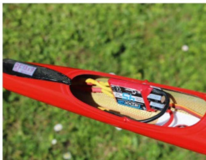
L'espace permet d'installer un accu LiPo 3S 1 300 mAh, le contrôleur 45 A étant fixé le long d'un des flancs. La fixation de la verrière est un peu lâche d'origine, il faudra la fiabiliser.
