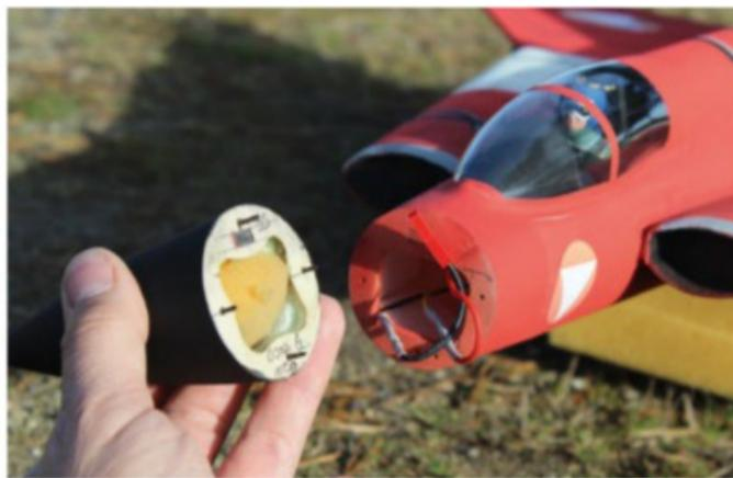
L'accu LiPo 3S 360 mAh sera installé dans le nez, qui est maintenu par des joncs en carbone et deux aimants.
