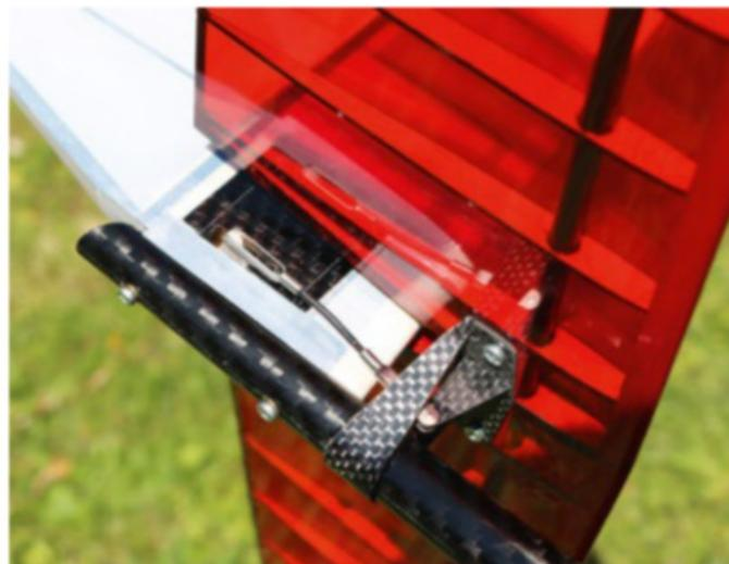
Le stabilisateur monobloc est installé sur un chevalet articulé. Le servo est en place dans la dérive.
