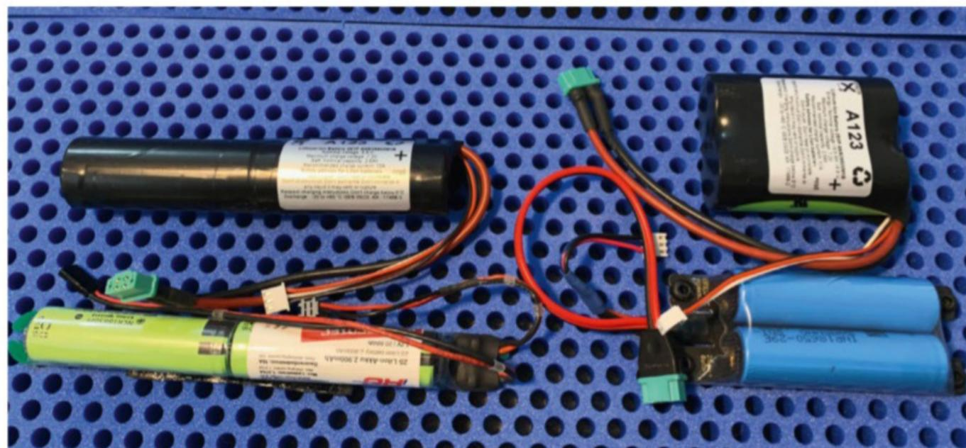
Lilon et LifePO4 : ces derniers sont plus gros mais parfaitement adaptés aux servos « non HV ». Montage en long ou côte à côte, notez les prises de puissance, pour une connexion de qualité.
