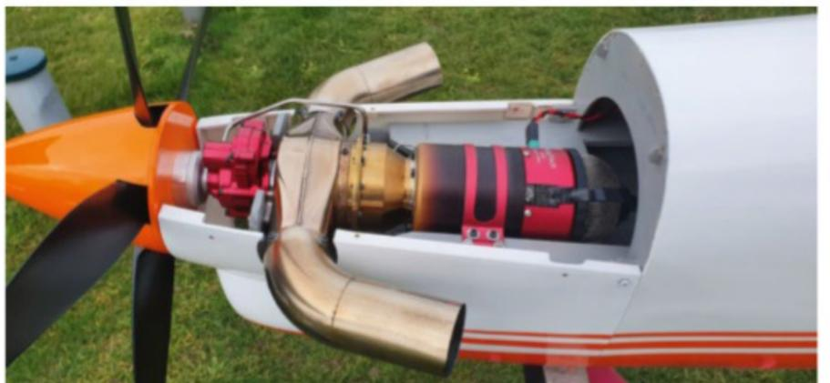
Le capot en deux parties assure un bon accès au turbopropulseur. Le Kingtech TP-45 ne pèse que 1800 g. À plein gaz, sa consommation est de 180 ml/min (données constructeur).
