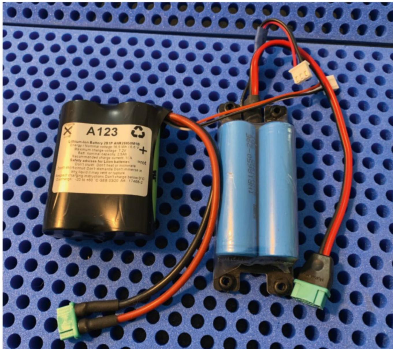
LiFePO4 6,6 V et 2500 mAh à gauche, Lilon 8,1 V et 2900 mAh à droite : de quoi assurer de longues heures de vol dans une parfaite sécurité. Noter la qualité des prises.
