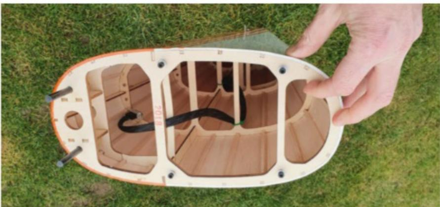
Voici la partie arrière du fuselage. La structure bois est entièrement coffrée et très légère. L'assemblage avec la partie avant est facile et rapide.
