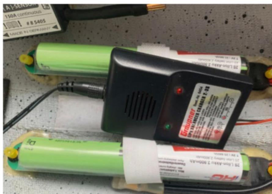
N'utilisant que sa prise d'équilibrage (format EH), ce type de petit chargeur est pratique pour charger les Lilon directement à bord du modèle.
