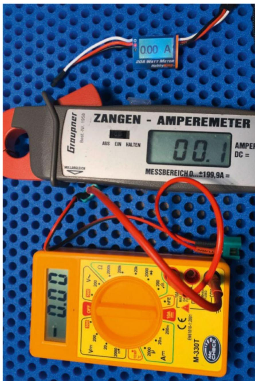
Il est peut être très utile de contrôler la consommation de vos servos soit individuellement, soit globalement, afin de détecter un servo qui force ou qui chauffe anormalement. Le petit ampèremètre en haut est très pratique pour comparer l'intensité entre deux servos : un test simple peut éviter bien des crash.
