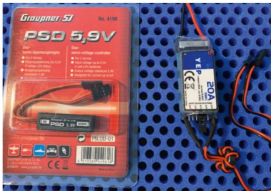
Un Ubec pour deux servos (Graupner), et un Sbec 20 A (YEP) utile pour certains modèles dont la réception sera alimentée par l'accu de propulsion.
