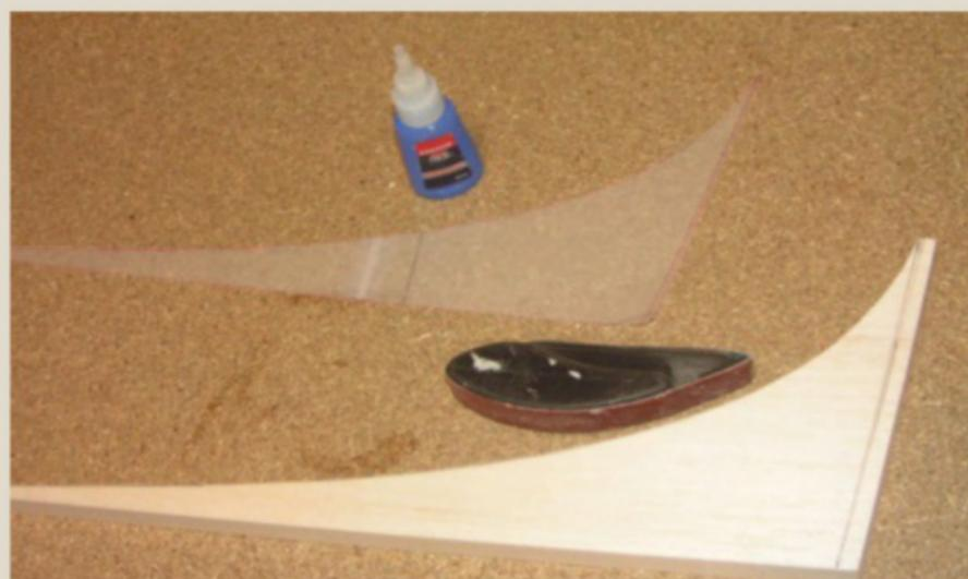
qui sauve la mise. Lorsque le calque est terminé, on le découpe précisément avec des ciseaux, il ne reste plus qu'à reproduire le dessin directement sur le bois, ici une planchette de balsa légère de 20 mm d'épaisseur. On termine par la découpe du bois à l'aide d'une scie à chantourner, à main ou électrique, un ponçage de mise en forme permet de bien coller au traçage.
