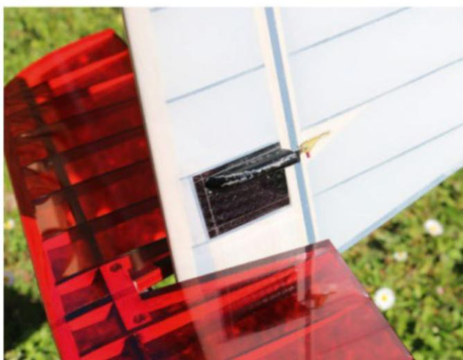
Le servo de direction est installé dans l'épaisseur de la partie fixe.
