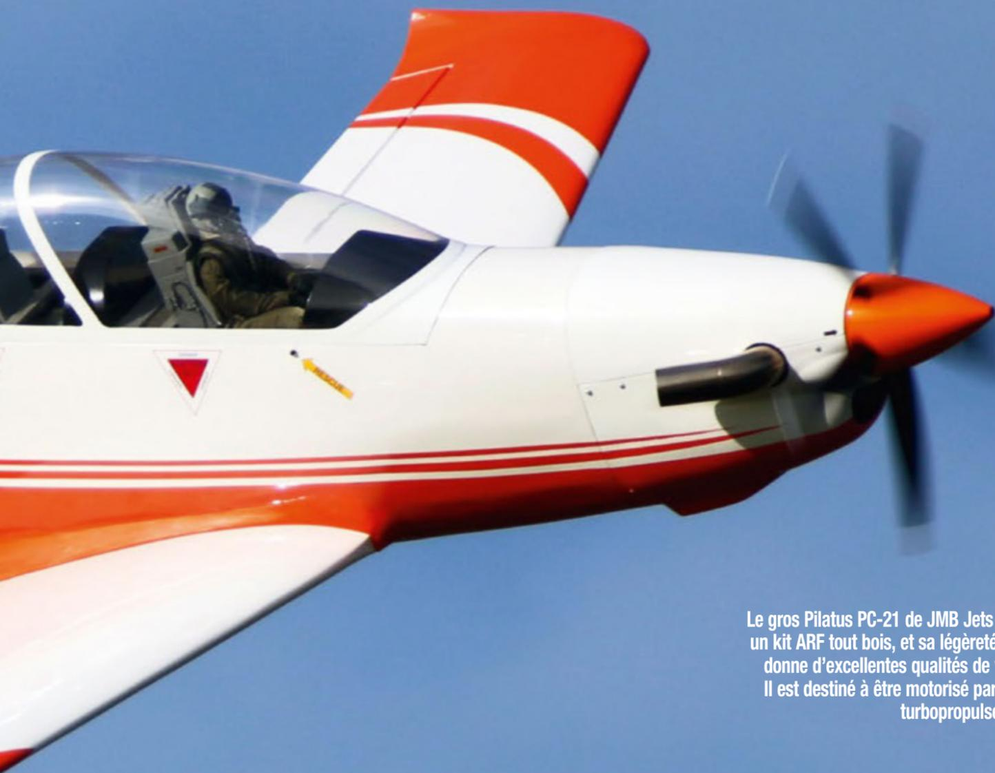
Le gros Pilatus PC-21 de JMB Jets est un kit ARF tout bois, et sa légèreté lui donne d'excellentes qualités de vol. Il est destiné à être motorisé par un turbopropulseur.
