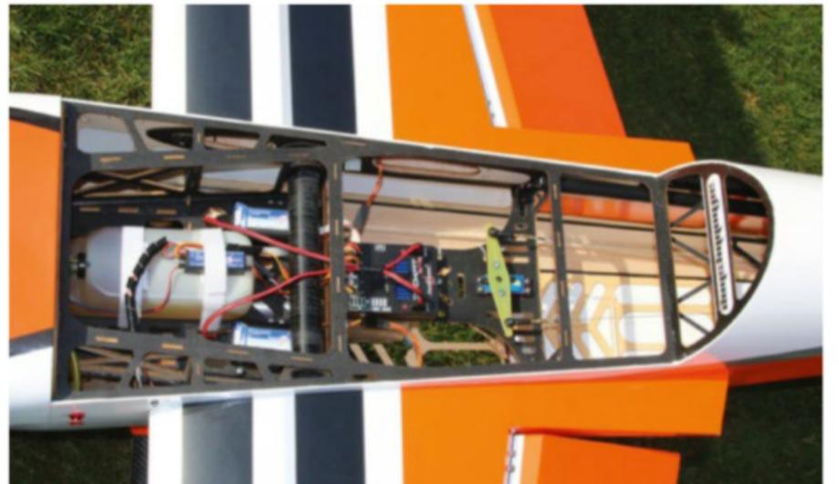
Le fuselage est largement évidé pour gagner du poids, et la rigidité est obtenue grâce à l'utilisation massive d'une fine couche de carbone collée directement sur les pièces en bois.
