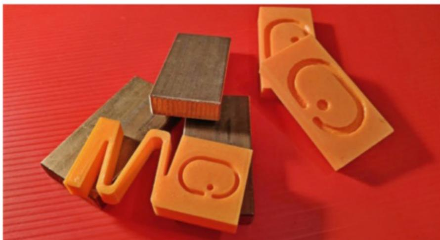
L'auteur a réalisé une cale « élastique » en impression 3D, qui se comprime en emboîtant les ailes et permet de bien caler les ballasts.
