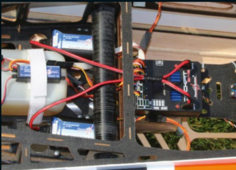
Sur un tel avion, la fiabilité est de mise et l'alimentation radio est confiée à une PowerBox Cockpit SRS et des accus Li-Ion PowerPack 2500 mAh de la même marque.
