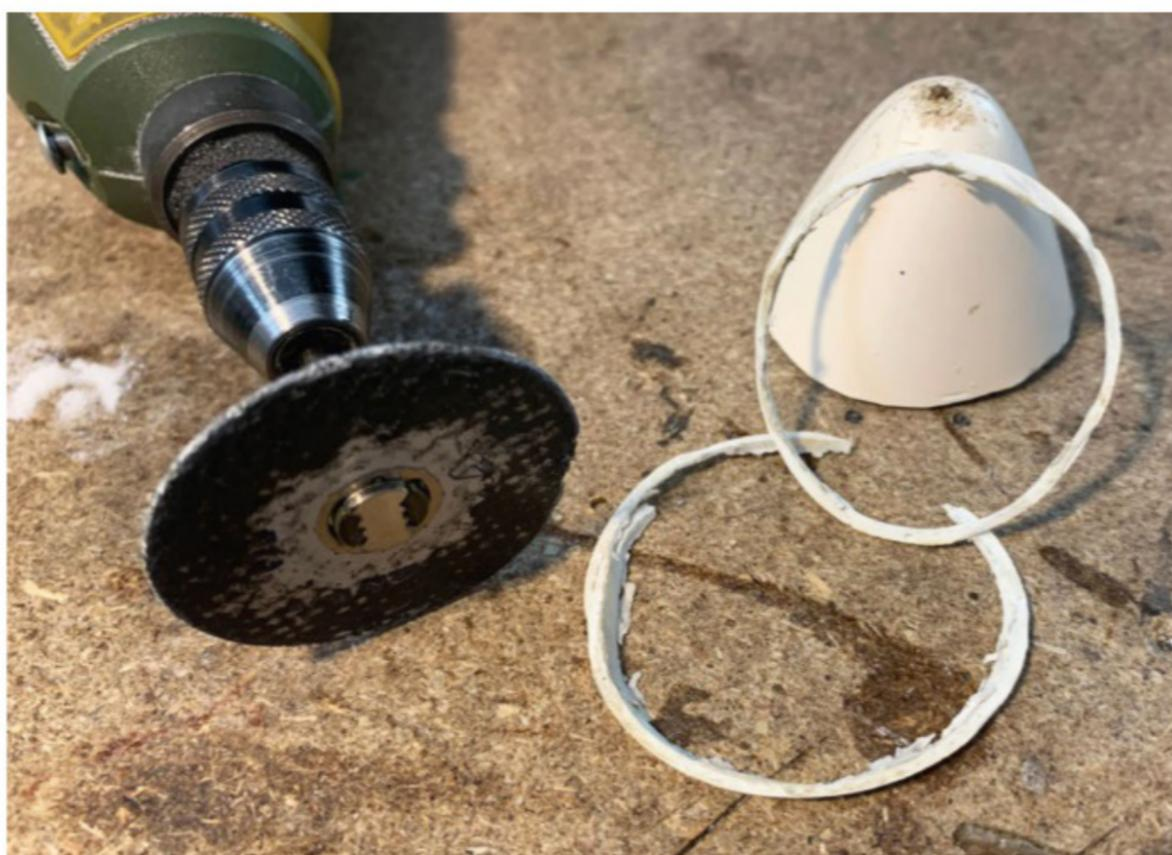
Couper le nez du planeur petit à petit permet d'ajuster progressivement la position du cône au fuselage.
