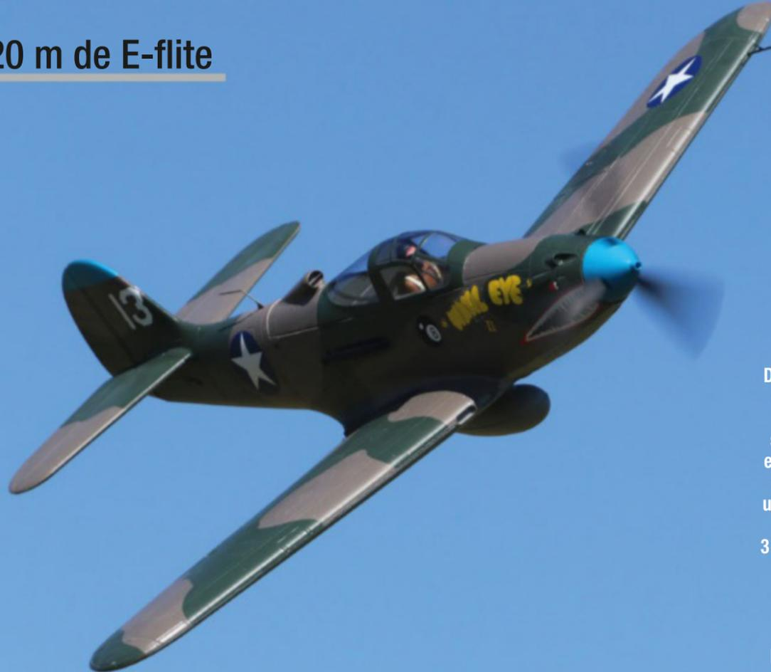
Dans la version BNF, la stabilisation AS3X fait merveille, le P-39 est sur des rails et mettra en confiance la plupart des pilotes. Les accus utilisables vont du LiPo 3S 2200 mAh au 4S 3000 mAh, des formats très répandus.
