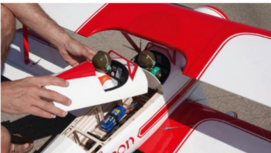
Les deux postes de pilotage sont équipés d'un buste de pilote qu'il reste à coller. Le poste arrière est démontable: c'est l'unique point d'accès à l'intérieur de l'avion.
