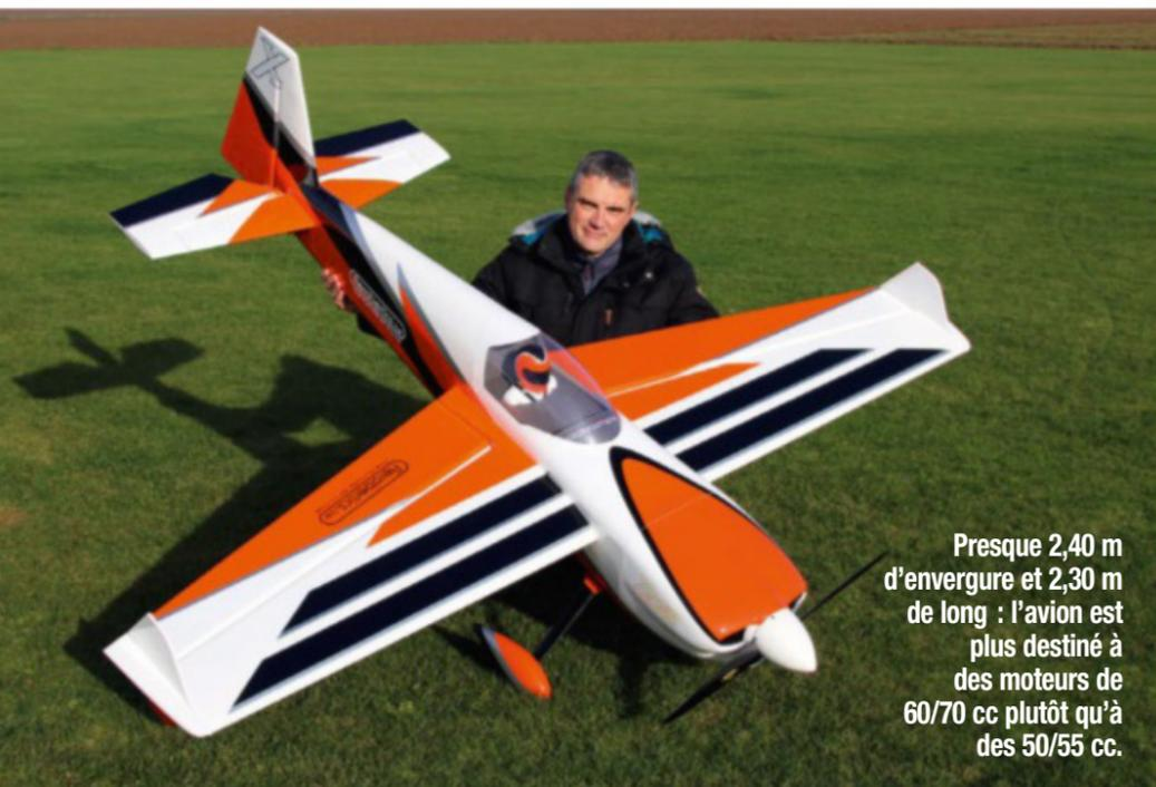
Presque 2,40 m d'envergure et 2,30 m de long : l'avion est plus destiné à des moteurs de 60/70 cc plutôt qu'à des 50/55 cc.
