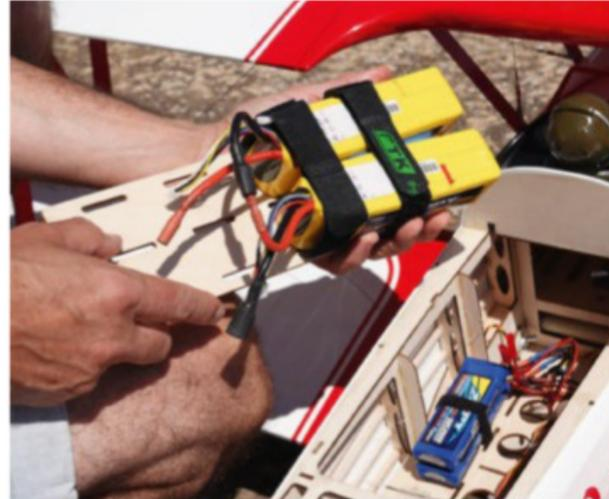
L'accu de propulsion est constitué de deux LiPo 5S 5000 mAh branchés en série pour former un 10S. Ils sont sanglés sur une platine à l'extérieur de l'avion, platine qui est ensuite glissée dans la cellule. Le tout doit être positionné le plus en avant possible pour assurer le centrage.
