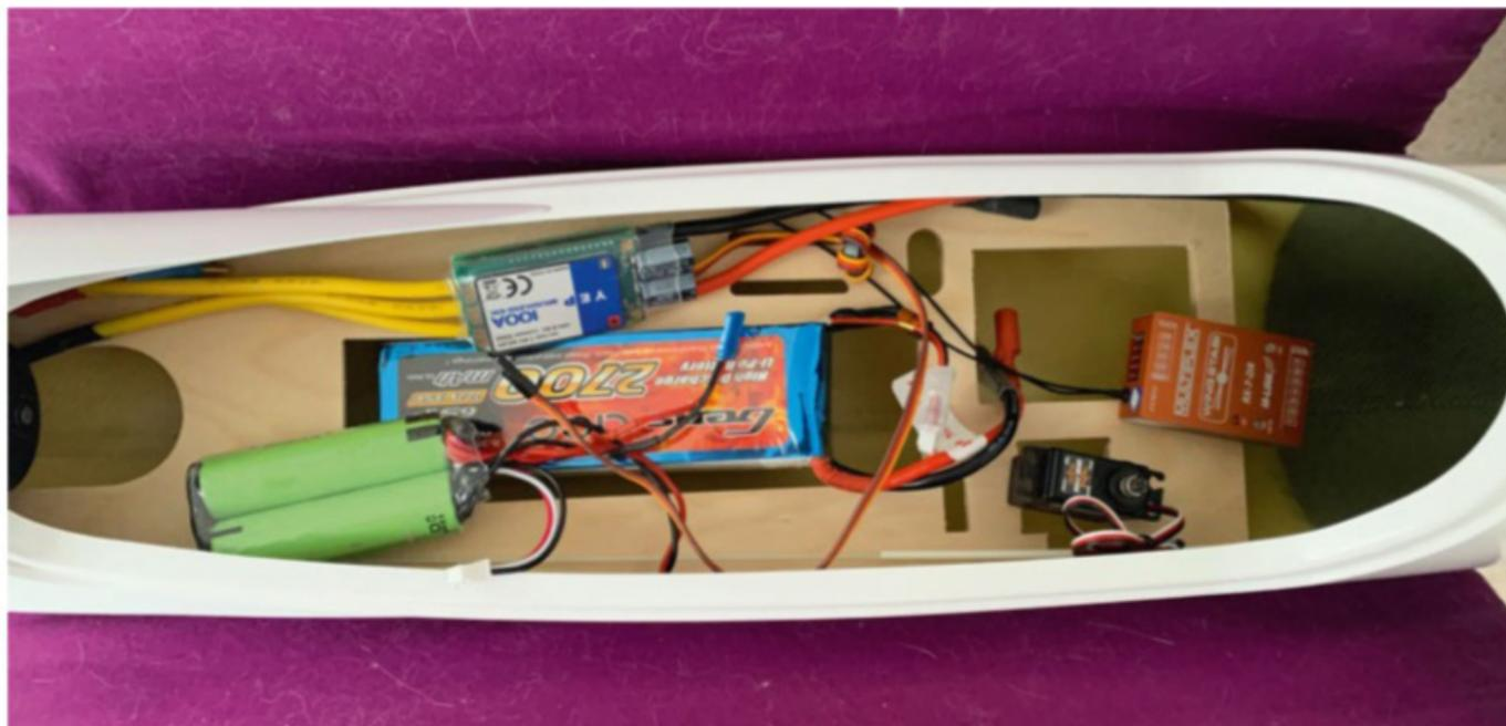
La platine d'origine de ce planeur n'est pas adaptée au meilleur centrage car elle positionne l'accu de propulsion en son centre, alors que celui-ci ira finalement sous la clé d'ailes: d'où l'intérêt de s'occuper de coller la platine quand tous les autres éléments du planeur sont en place...
