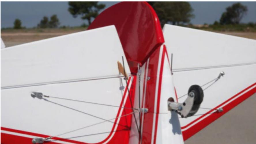
Le stabilisateur est haubané avec des câbles pour le rigidifier. La roulette de queue n'est pas maquette mais elle est amortie.
