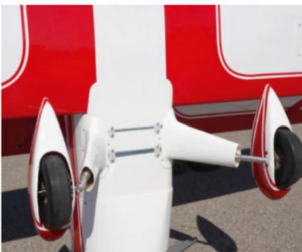
Les jambes de train sont en CAP de 5 mm pour la partie haute, avec des jambes amorties en aluminium pour la partie basse. Le tout est coiffé avec des pantalons de train très esthétiques en fibre de verre.
