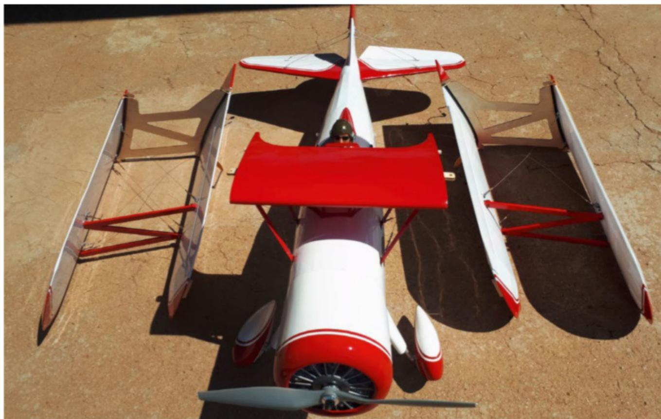
Pour réduire le temps de montage sur le terrain, Seagull fournit des supports qui permettent de transporter les ailes préassemblées. Mais l'ensemble est alors très encombrant...
