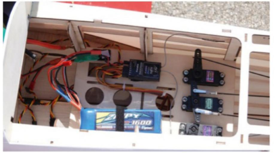
Les servos de profondeur (un par gouverne) et de dérive sont implantés sur une platine facilement accessible. L'installation est classique.
