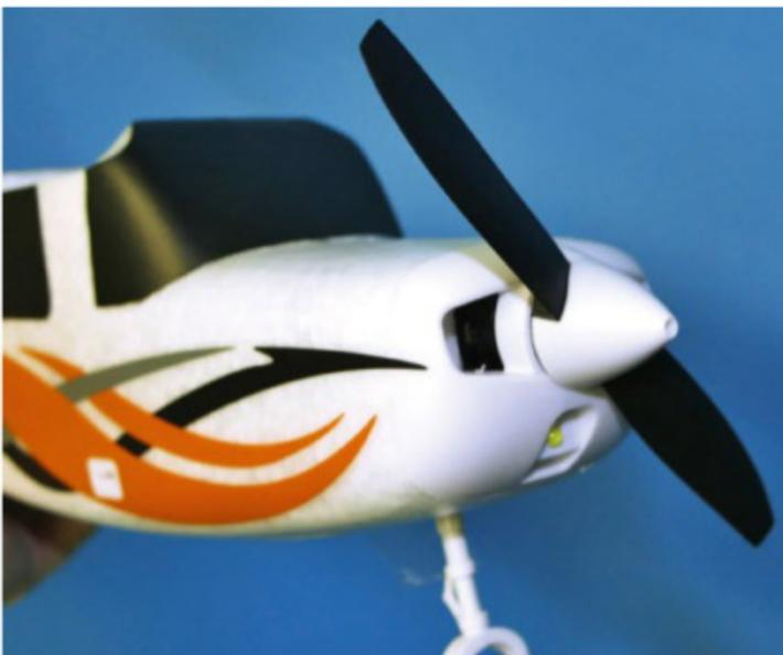
Sous l'hélice, la LED figurant le phare d'atterrissage sert aussi à donner le statut du GPS et du gyroscope.
