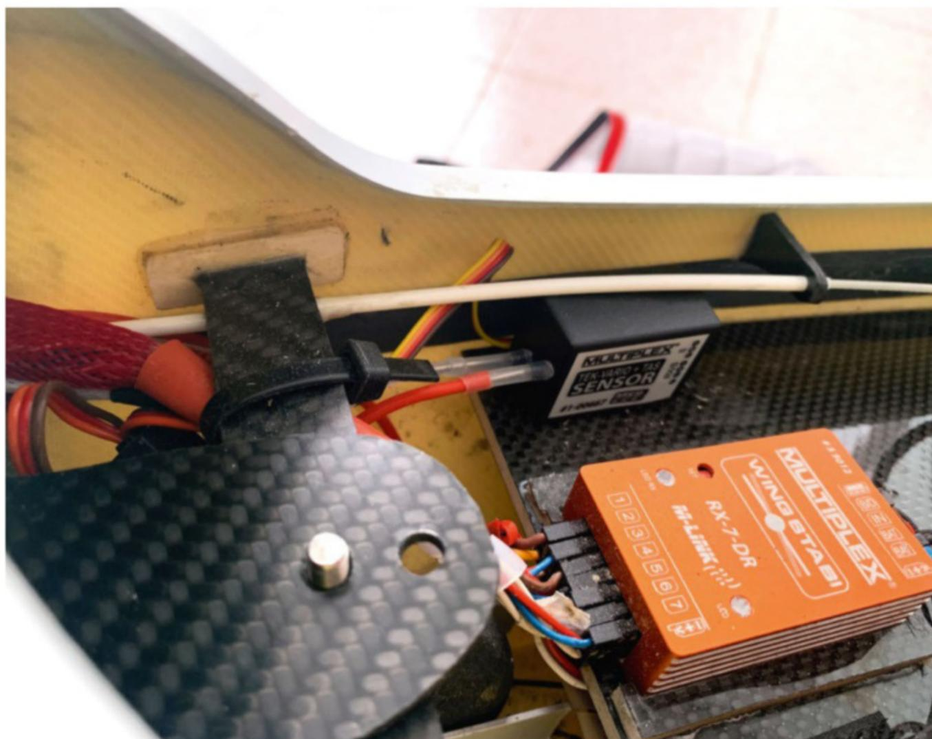
Gros plan sur la languette avant de la platine d'accu, où l'on voit sa fixation et le principe de réglage du centrage.
