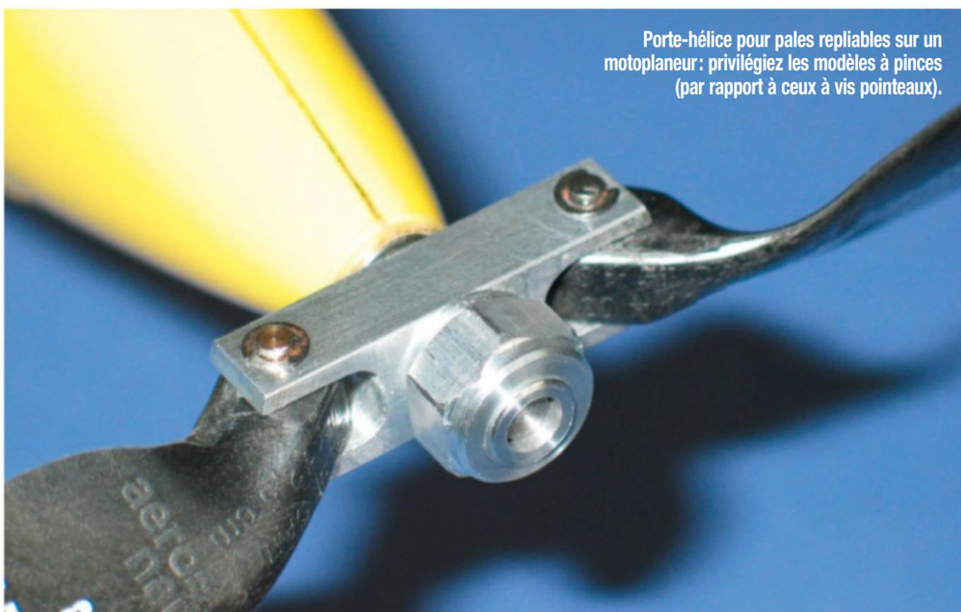
Porte-hélice pour pales repliables sur un motoplaneur: privilégiez les modèles à pinces (par rapport à ceux à vis pointeaux).
