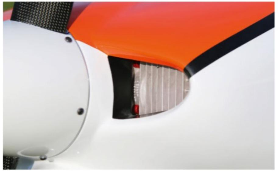
Des lèvres en fibre de verre sont fournies pour canaliser l'air sur les deux cylindres à plat du moteur DA-70.
