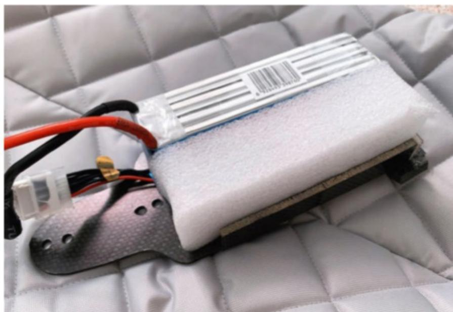
Placée en position centrale, cette platine permet de faire varier la charge alaire avec un ou deux accus de propulsion (le second ne servant que de ballast), soit 420 g de plus ou de moins pour ces 6S 2700 mAh.
