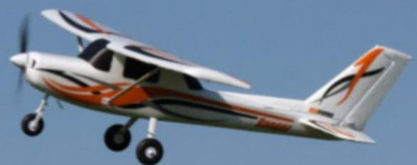
Grâce à ses aides électroniques, le vol de ce petit avion est à la portée d'un débutant qui sera encadré par un moniteur. L'accu LiPo 2S 850 mAh permet de voler une dizaine de minutes.
