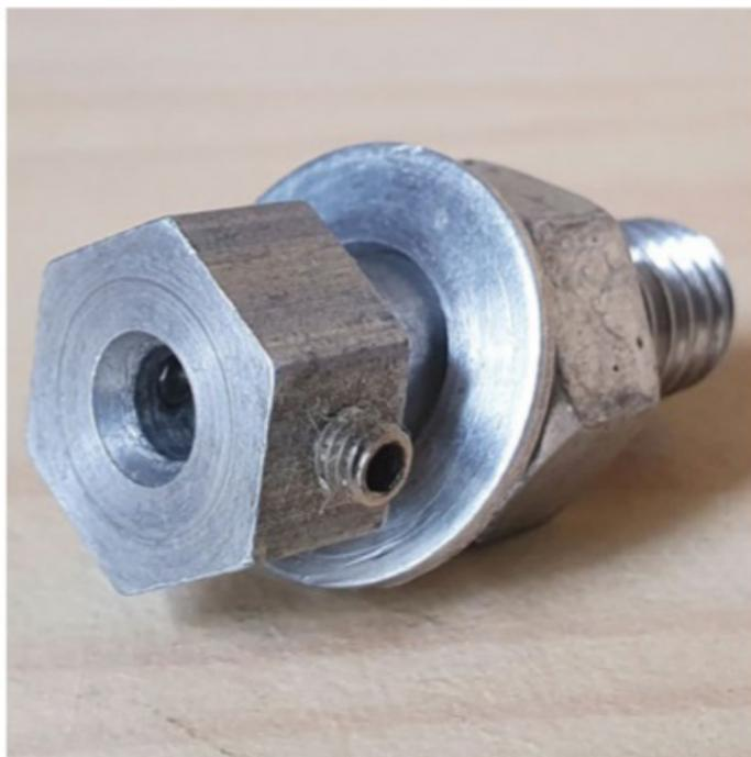
Un support d'hélice à vis pointeau, plutôt adapté aux moteurs à faible puissance.
