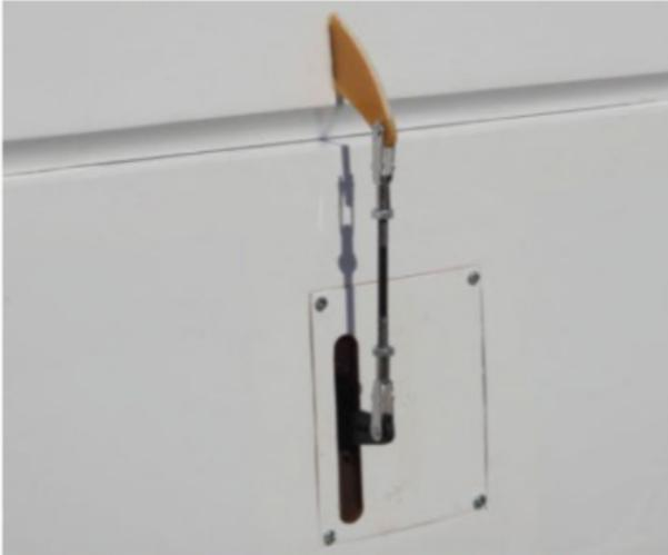
Les ailerons sont implantés uniquement sur les ailes inférieures. Les servos, fixés aux dos de trappes, sont complètement intégrés dans l'épaisseur du profil.
