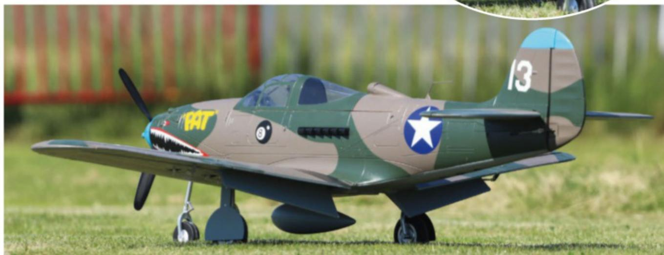
Avec sa configuration de train d'atterrissage tricycle et sa faible charge alaire, ce warbird présente une réelle facilité de mise en œuvre et se comporte comme un avion de transition.
